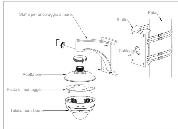
INSTALLAZIONE TIPO A MURO DI TELECAMERA DOME DA ESTERNO
