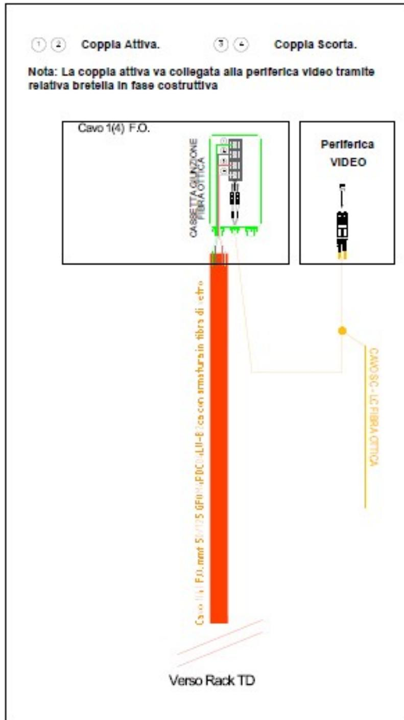
Figura 12 - Dettaglio allacciamento ottico lato piazzale
