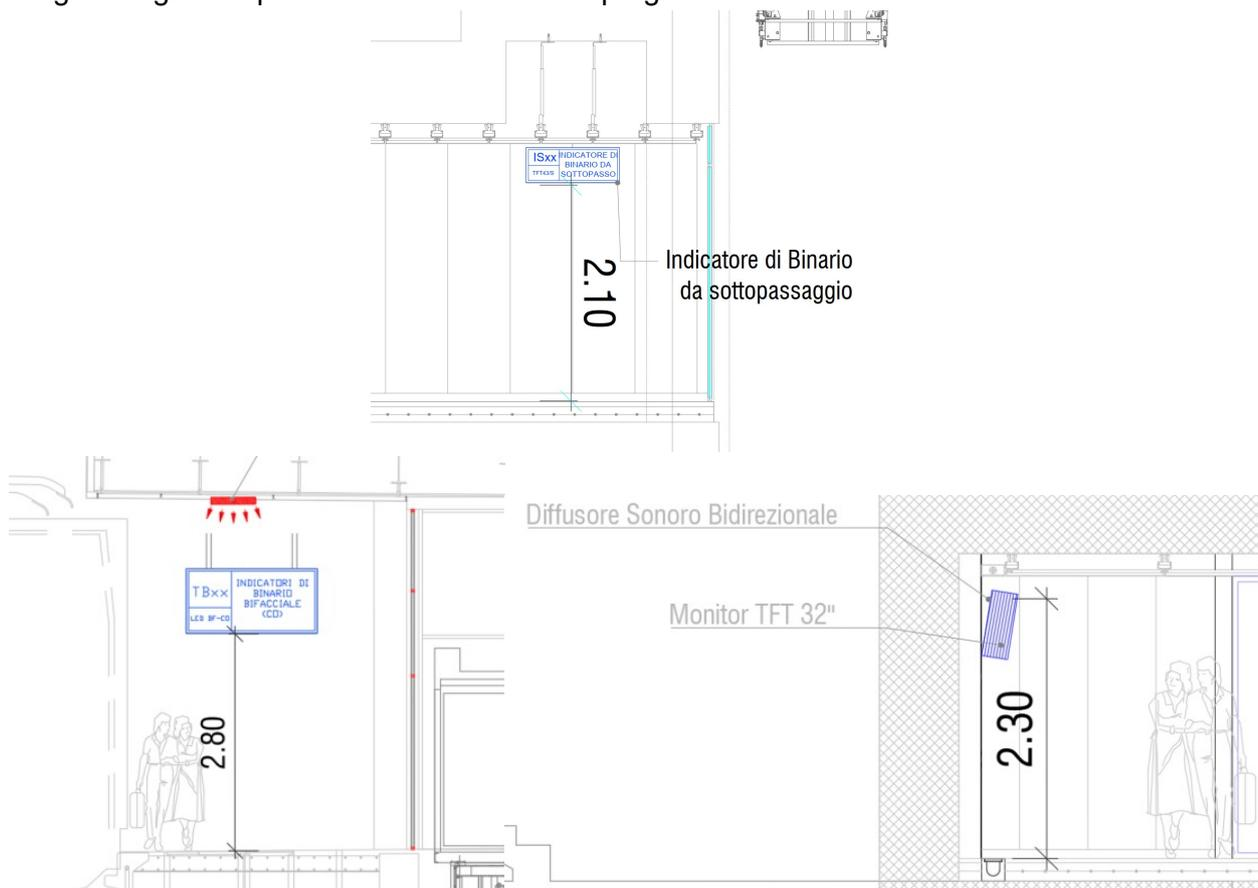
**Figura 5 – Vista in sezione posizionamento monitor valida per entrambe le fermate**
