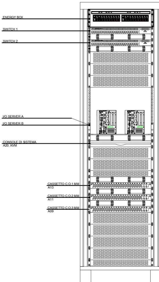
Figura 8 - Fronte Rack TD valido per entrambe le fermate
