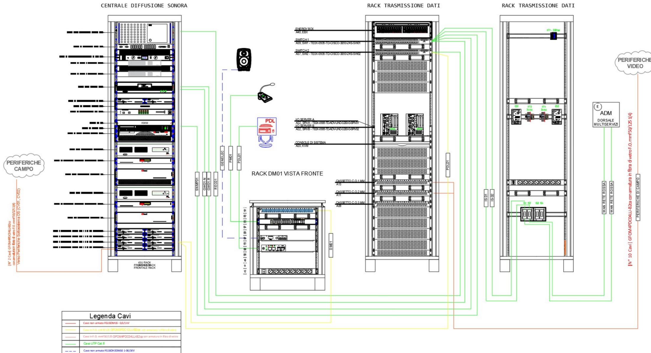
Figura 3 – Architettura generale di impianto applicabile per entrambe le stazioni in oggetto
