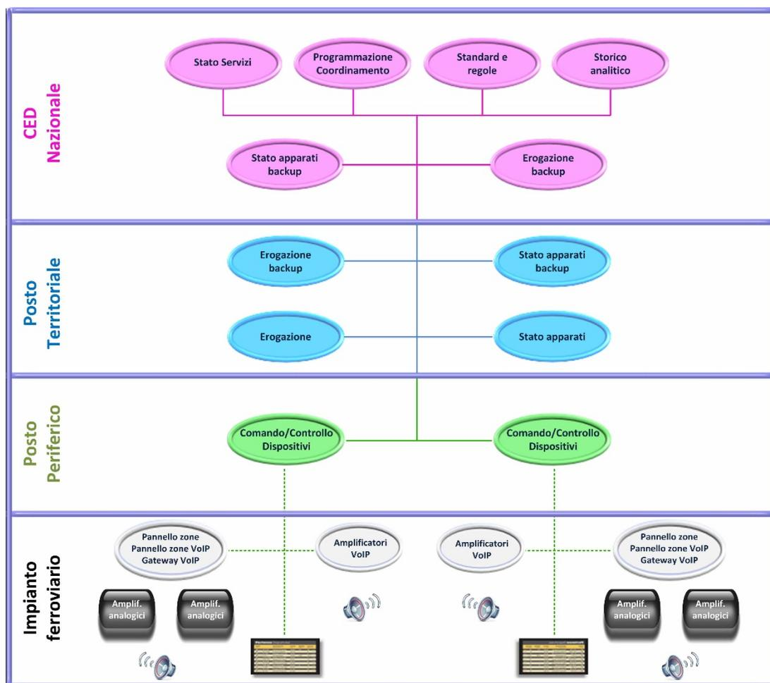
Figura 1 - Architettura generale del sistema IeC
