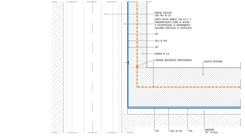
**GIUNTO IN COPERTURE INTERRATE**
