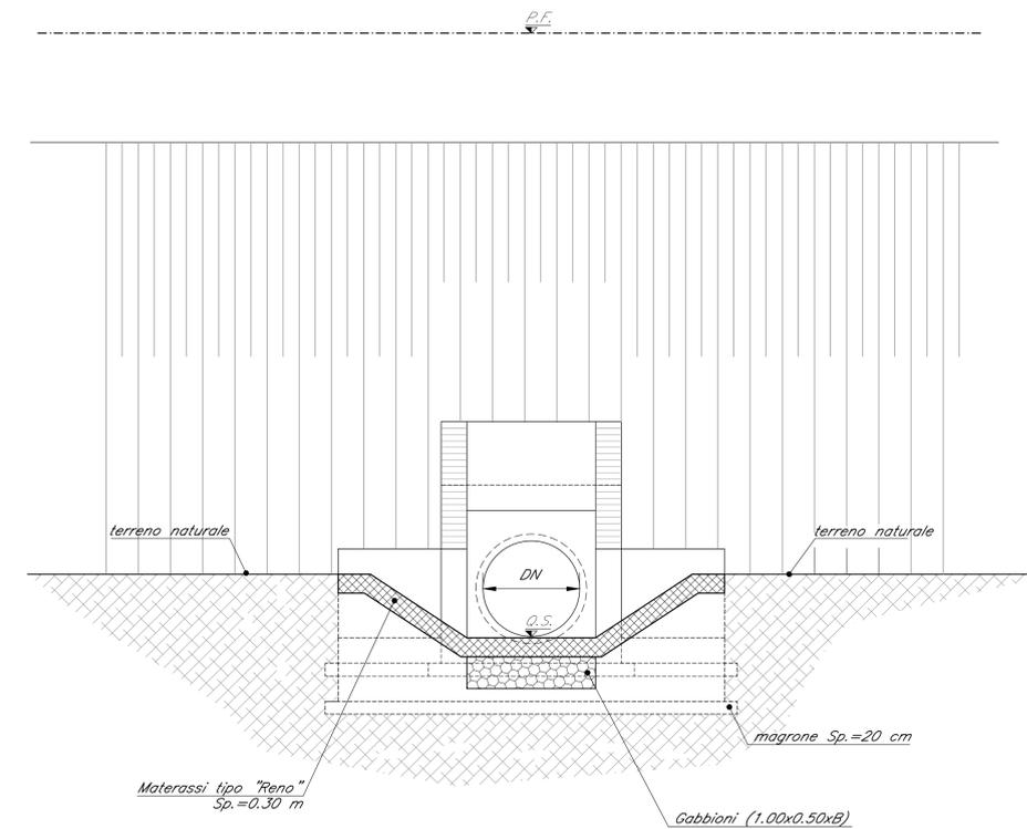
SEZIONE TIPO IMBOCCO SCATOLARE
