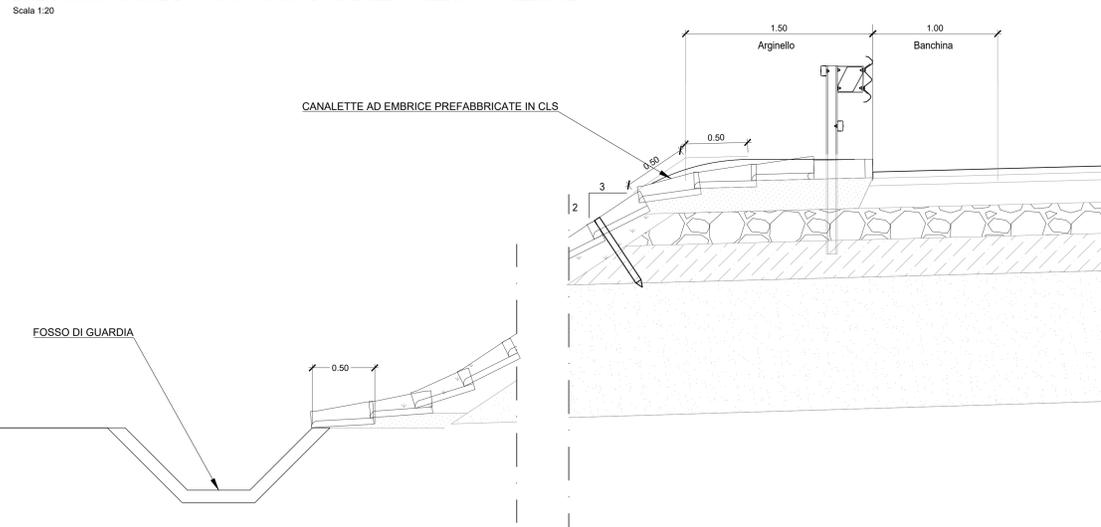
DRENAGGIO ACQUE DI PIATTAFORMA STRADALE IN TRINCEA - SEZIONE B-B
