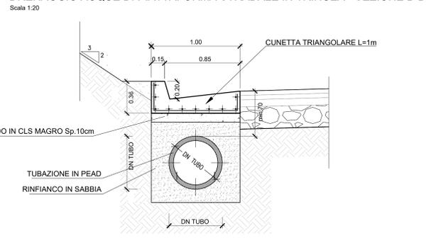
DRENAGGIO ACQUE DI PIATTAFORMA STRADALE IN TRINCEA - SEZIONE C-C
