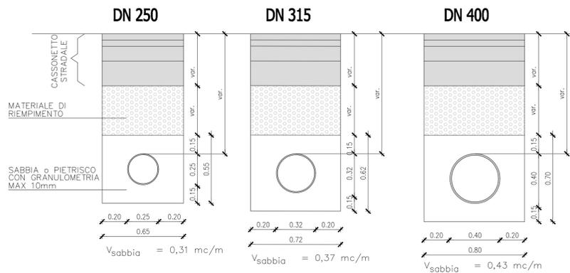
**TUBO IN PVC SN8 COMPATTO PER CONDOTTE DI SCARICO INTERRATE CONFORMI ALLE NORME IIP BVQI UNI EN 1401 Serie SN 8kN/mq**
