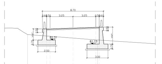
MURO IN DESTRA - SEZIONE TIPO A
