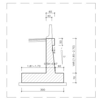
MURO IN SINISTRA - SEZIONE TIPO C
