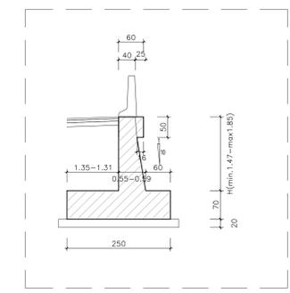
MURO IN DESTRA - SEZIONE TIPO B
