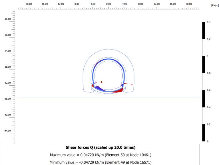
Figura 2-80. Rivestimento definitivo. Sforzo di taglio [kN/m /1000]
