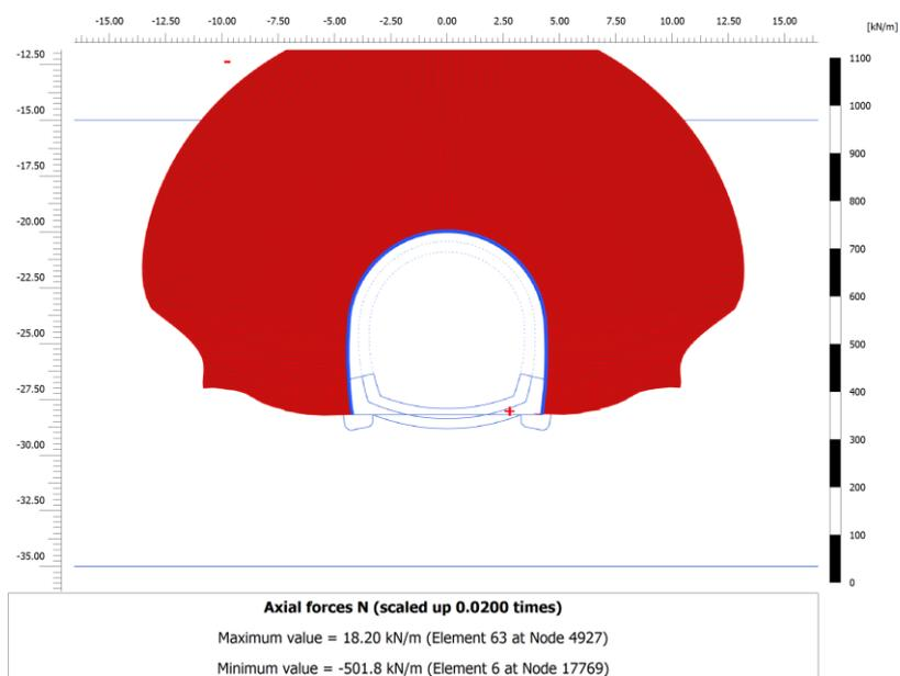
Figura 1-54. Rivestimento di prima fase. Sforzo normale [kN/m]
