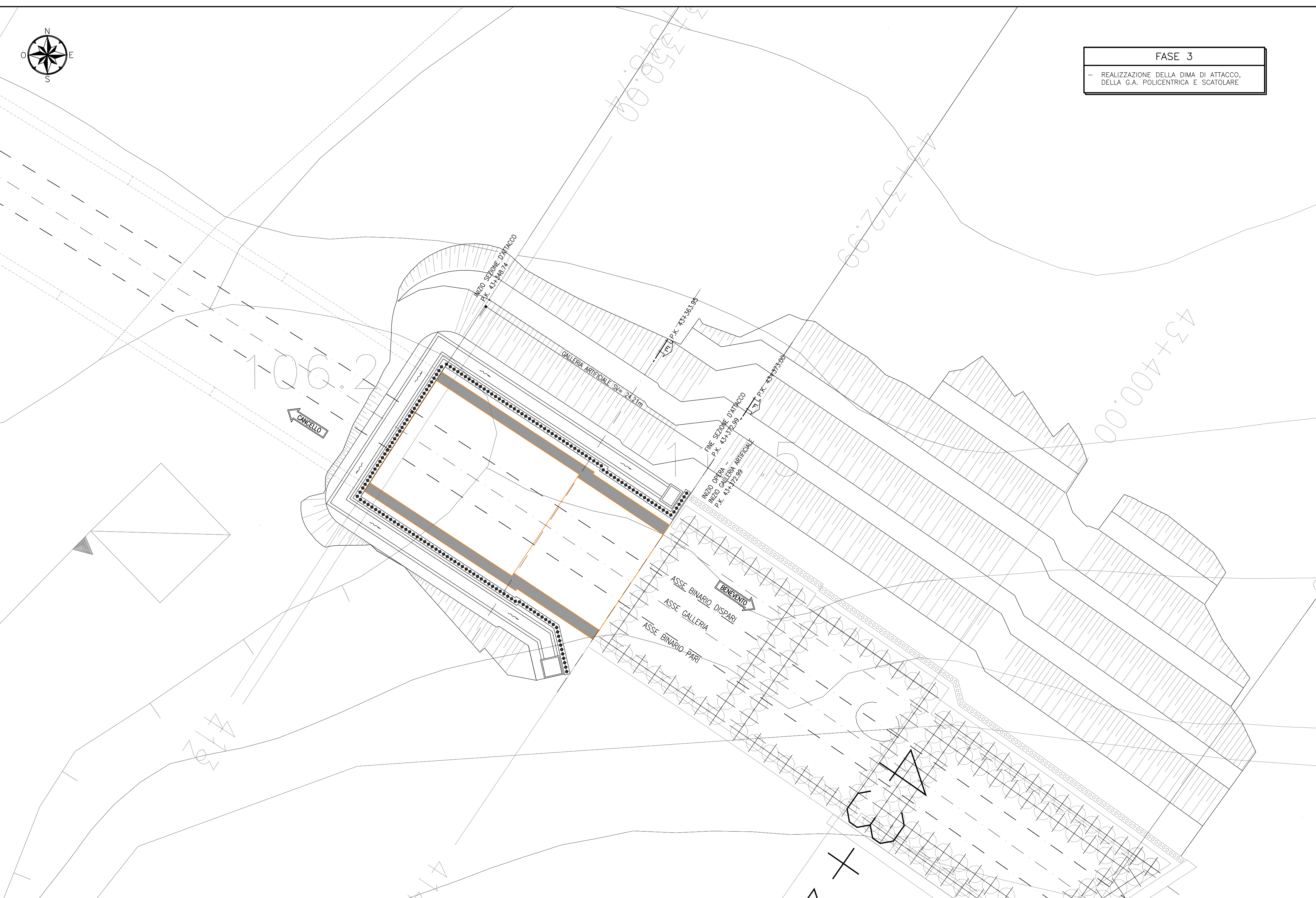
FASE 4 - RITOMBAMENTO E SISTEMAZIONE DEFINITIVA DELLA GALLERIA ARTIFICIALE
