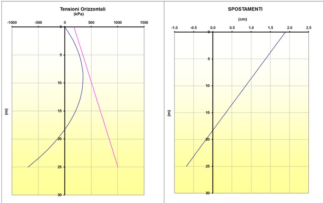
Figura 5 Diagramma delle tensioni orizzontali degli spostamenti orizzontali
