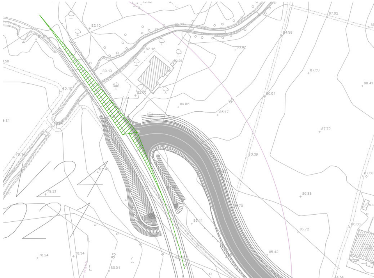
Figura 6 – Intersezione NV25 – NV24: verifiche di visibilità
