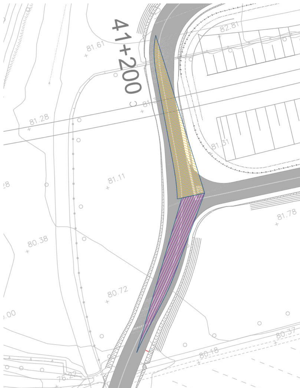
Figura 8 – Intersezione NV26 tratto1-tratto2: verifiche di visibilità
