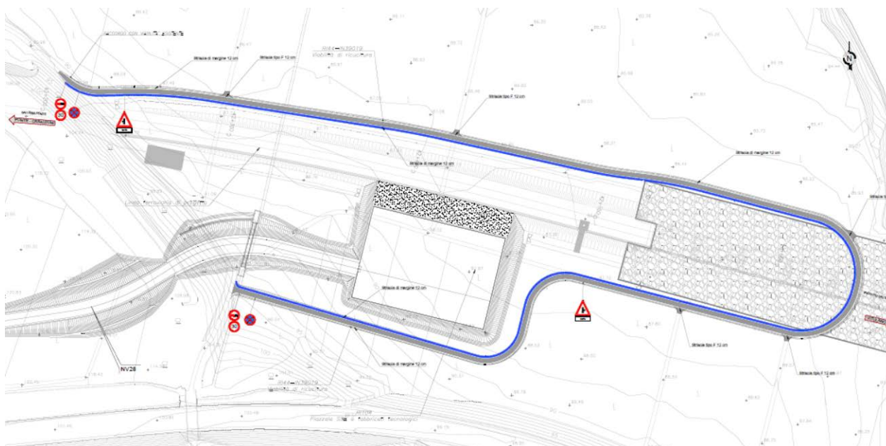
Figura 4- Barriere stradali e segnaletica
