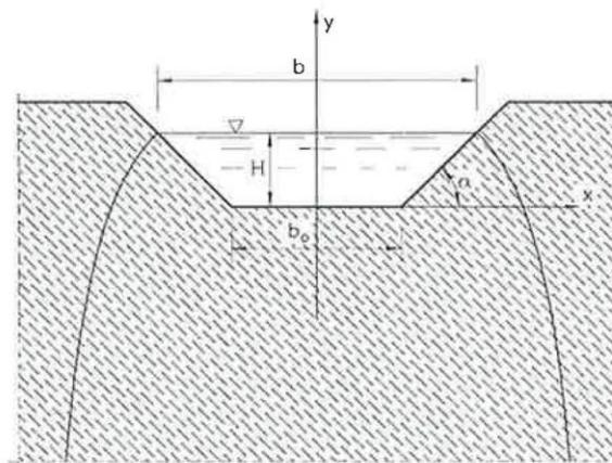
Figura 3: Schema funzionamento fossato dispersivo
