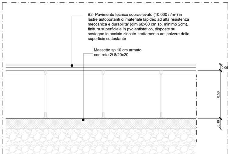
DETTAGLIO PAVIMENTO FLOTTANTE - B2
