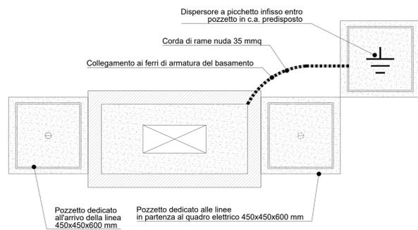
NOTA: DOVRA' ESSERE ASSICURATA L'EQUIPOTENZIALITA' CON L'IMPIANTO DI TERRA DELLA MAGLIA ELETTROSALDATA DEL BASAMENTO
