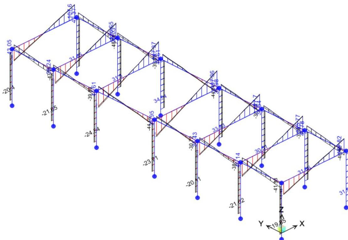
Figura 31: Diagramma forza di taglio V2; comb. env\_SLU
