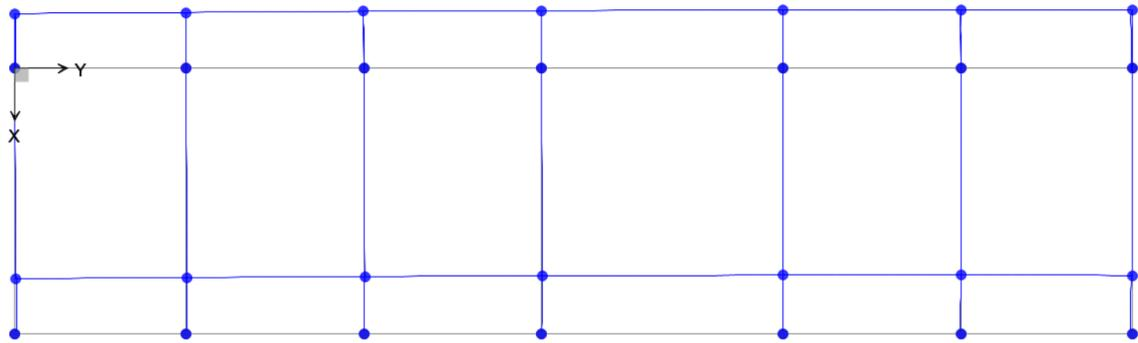
Figura 26: Forma modale 1 (dir. X); vista in pianta
