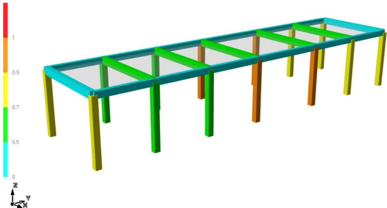
Figura 47: Struttura in elevazione; rapporti D/C verifiche di gerarchia a taglio, comb. SLV-SLD
