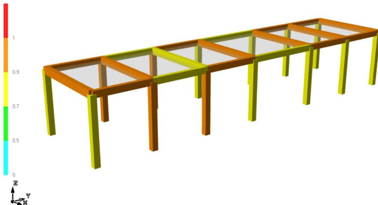
Figura 45: Struttura in elevazione; rapporti D/C verifiche PMM, comb. SLU-SLV-SLD
