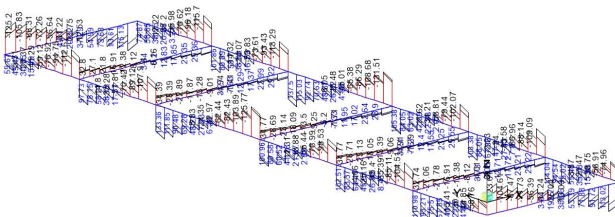
Figura 36: Diagramma forza di taglio V2; comb. env\_SLU
