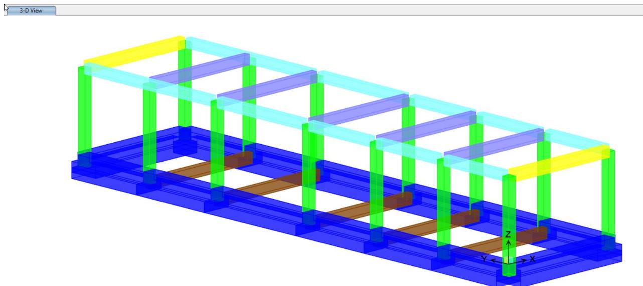
Figura 15: Modello di calcolo, vista assometrica elementi estrusi
