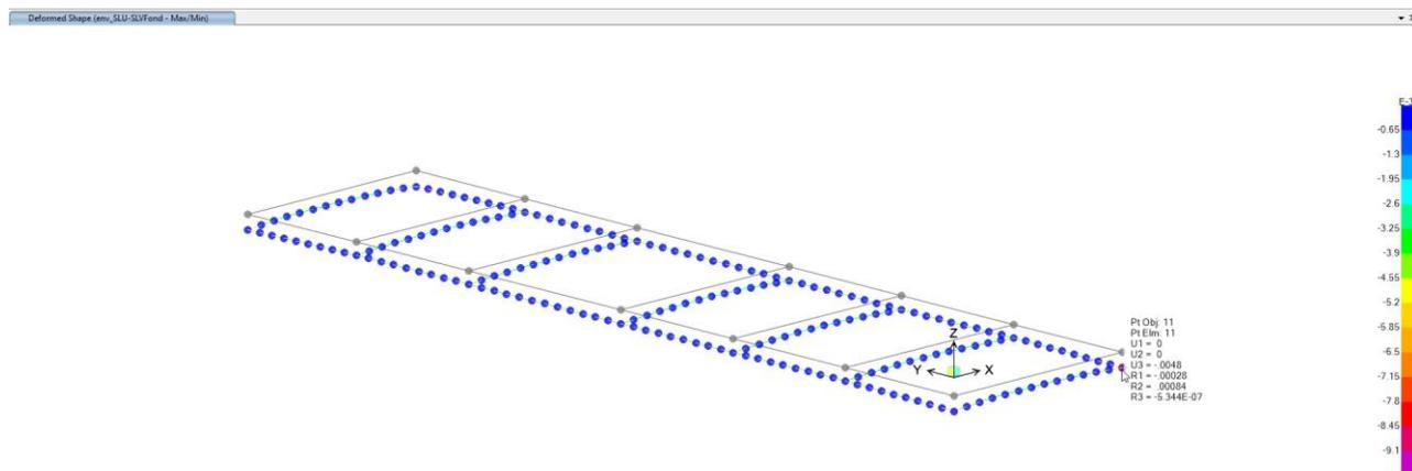
Figura 57: Diagramma involuppo spostamenti nodi fondazione; comb. env\_SLU/SLV
