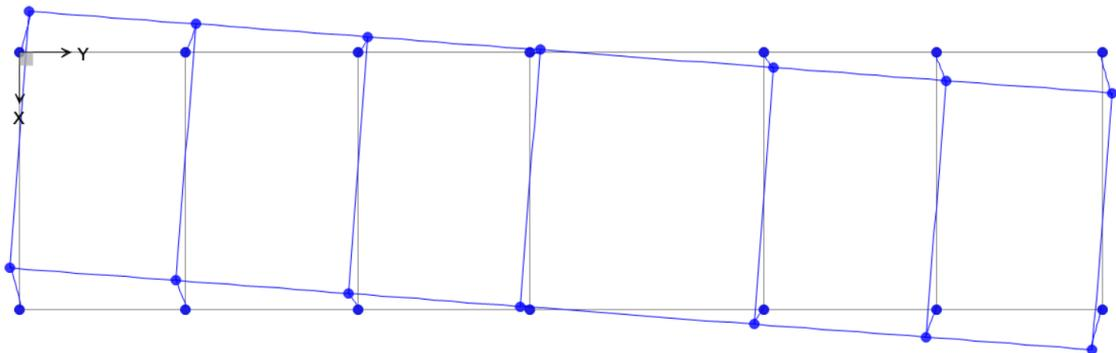
Figura 27: Forma modale 2 ; vista in pianta
