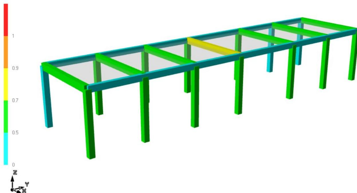
Figura 48: Struttura in elevazione; rapporti D/C verifiche tensionali in esercizio
