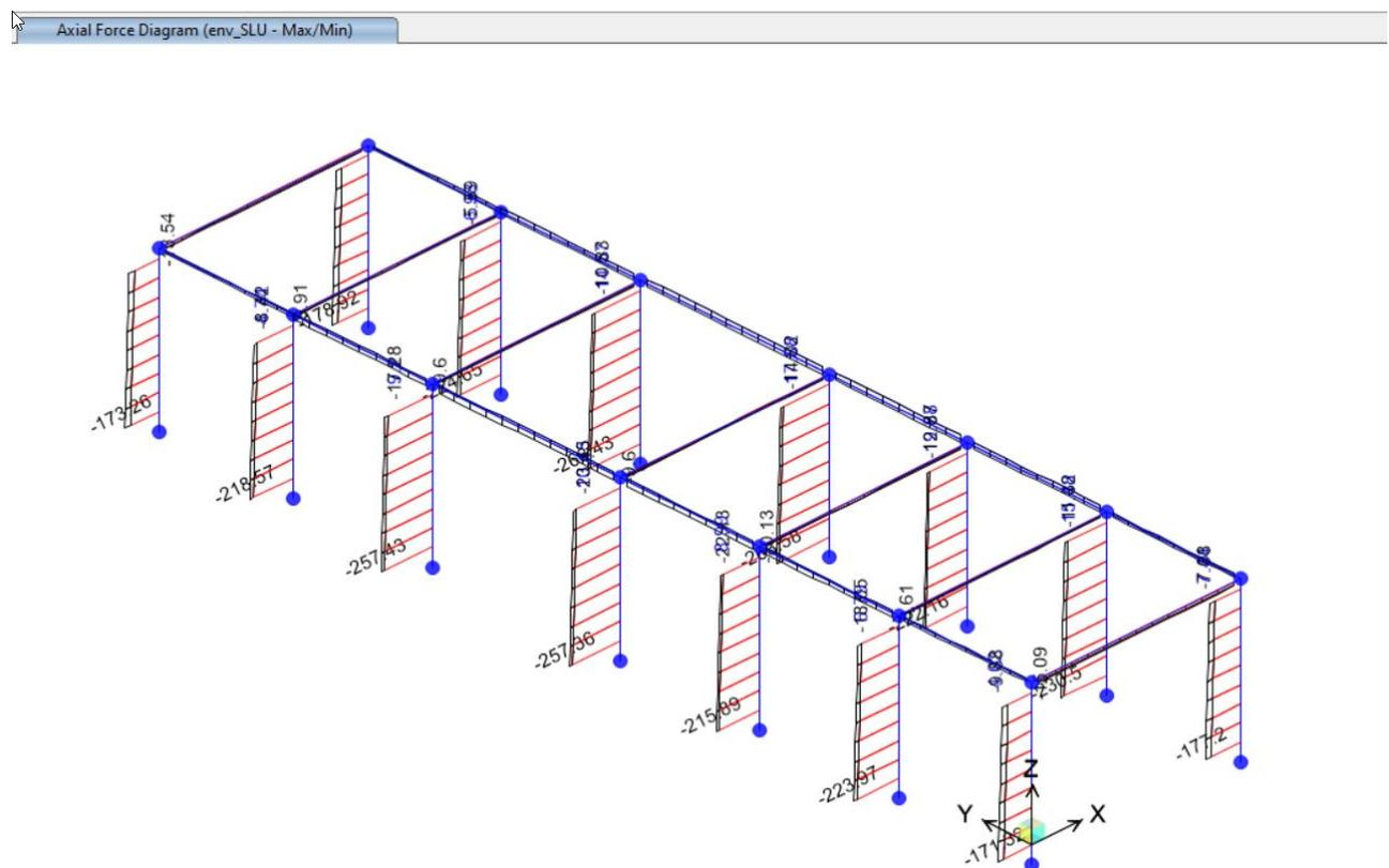
Figura 29: Diagramma sforzo normale N; comb. env\_SLU
