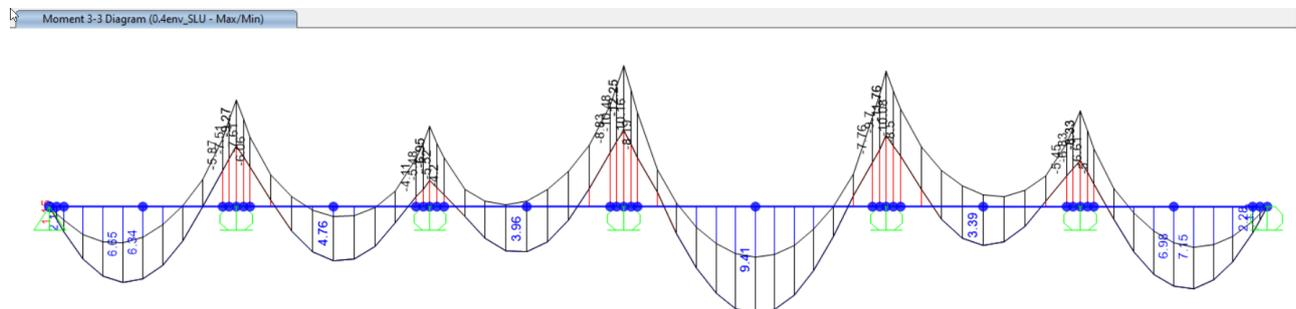
Figura 42: Diagramma momento flettente M3 – inviluppo SLU [kNm]
