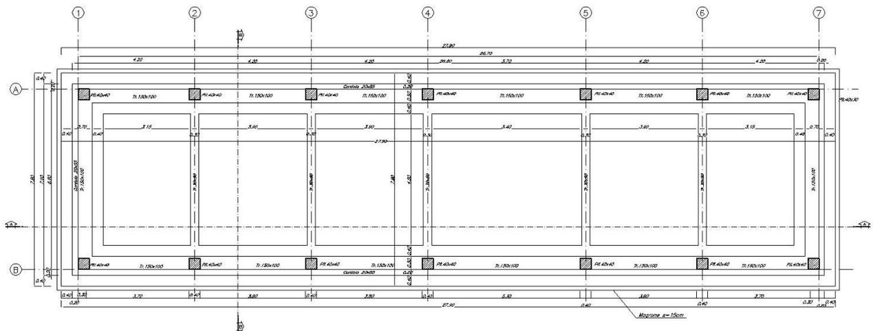
Figura 2: Carpenteria piano copertura
