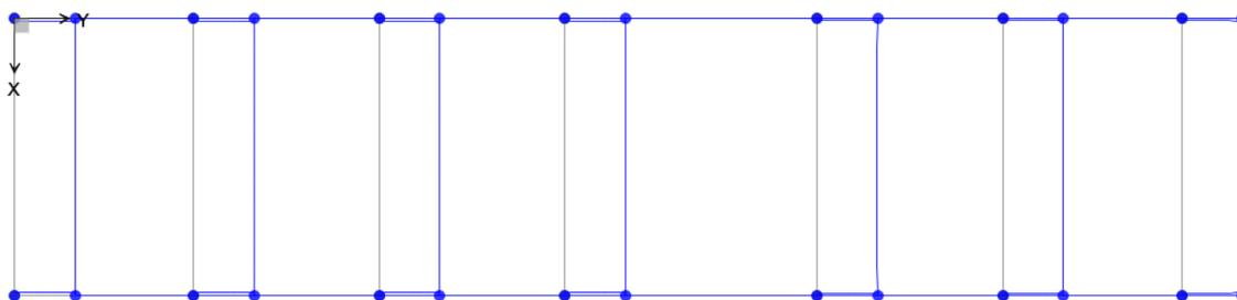
Figura 28: Forma modale 3 (dir. Y); vista in pianta
