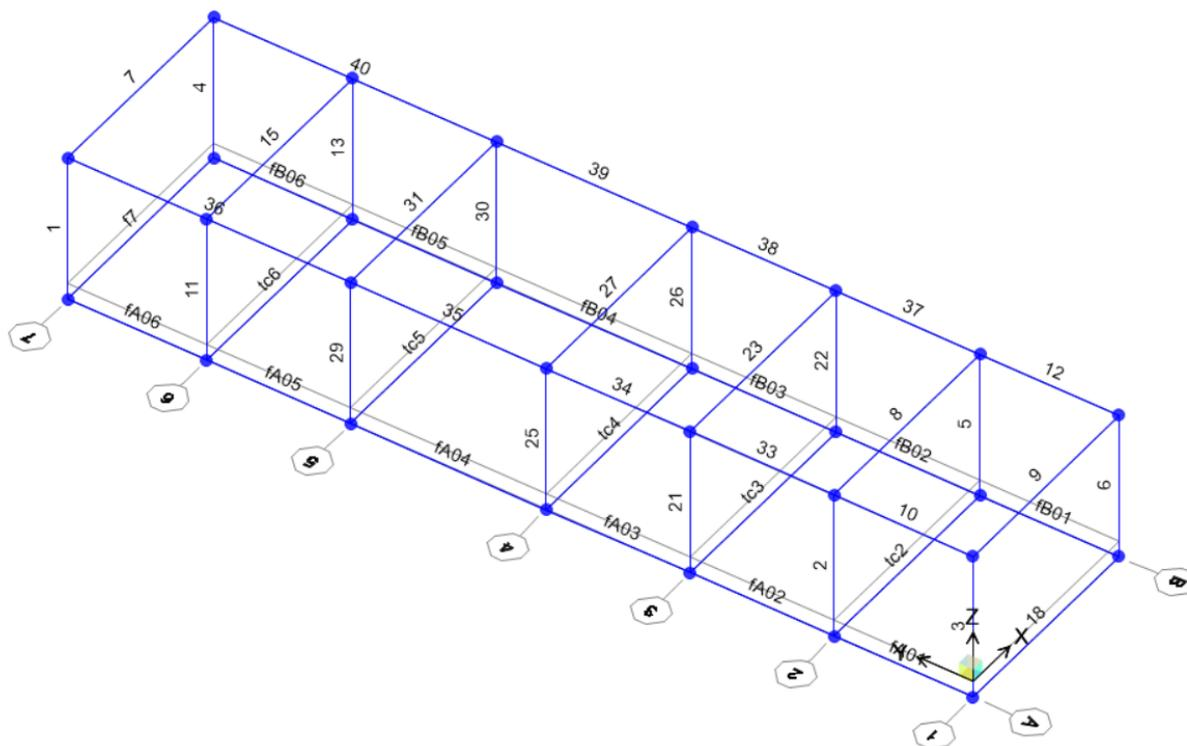
Figura 17: Modello di calcolo, numerazione aste
