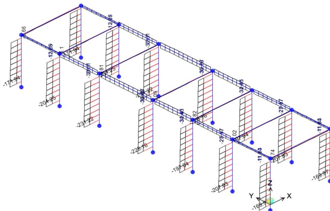
Figura 32: Diagramma sforzo normale N; comb. env\_SLV
