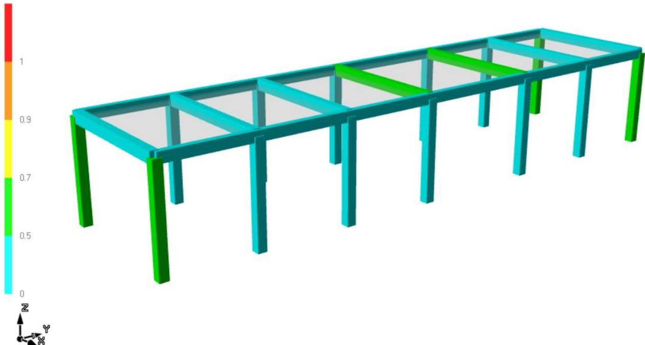
Figura 46: Struttura in elevazione; rapporti D/C verifiche a taglio, comb. SLU-SLV-SLD
