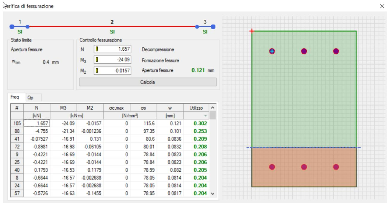
Figura 55: Verifica a fessurazione con rapporti D/C in comb. frequenti
