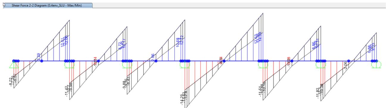
Figura 43: Diagramma forza di taglio V2 – inviluppo SLU [kNm]
