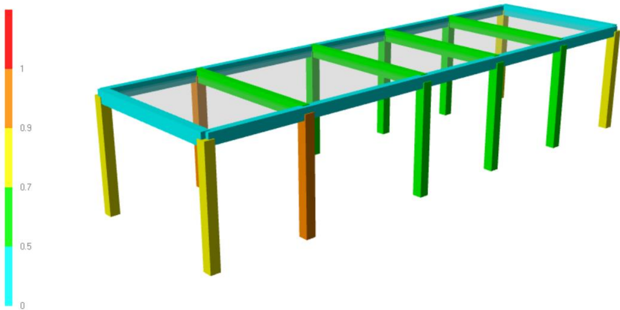
Figura 47: Struttura in elevazione; rapporti D/C verifiche di gerarchia a taglio, comb. SLV-SLD
