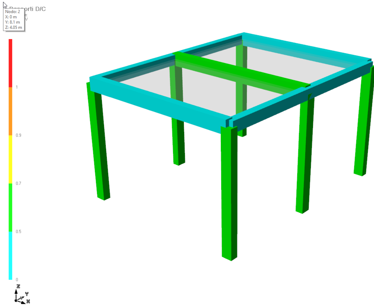
Figura 47: Struttura in elevazione; rapporti D/C verifiche di gerarchia a taglio, comb. SLV-SLD
