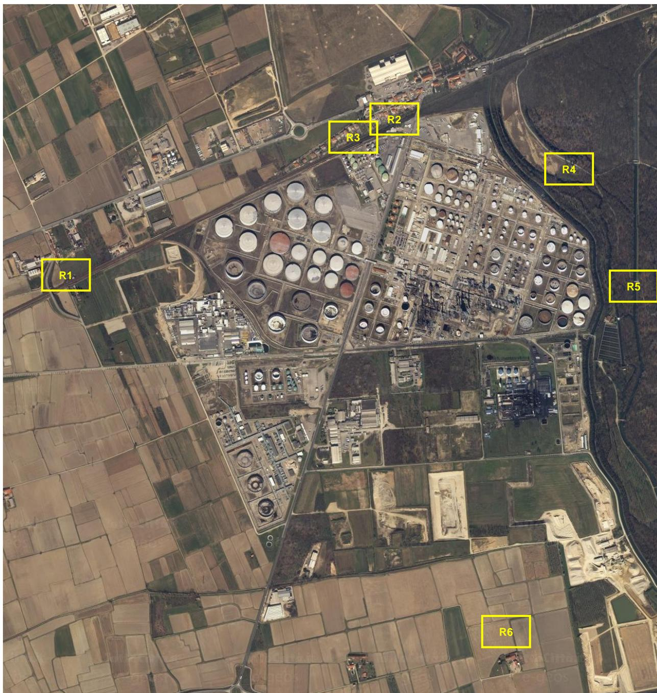
Figura 6: Punti di misura presso i principali ricettori
