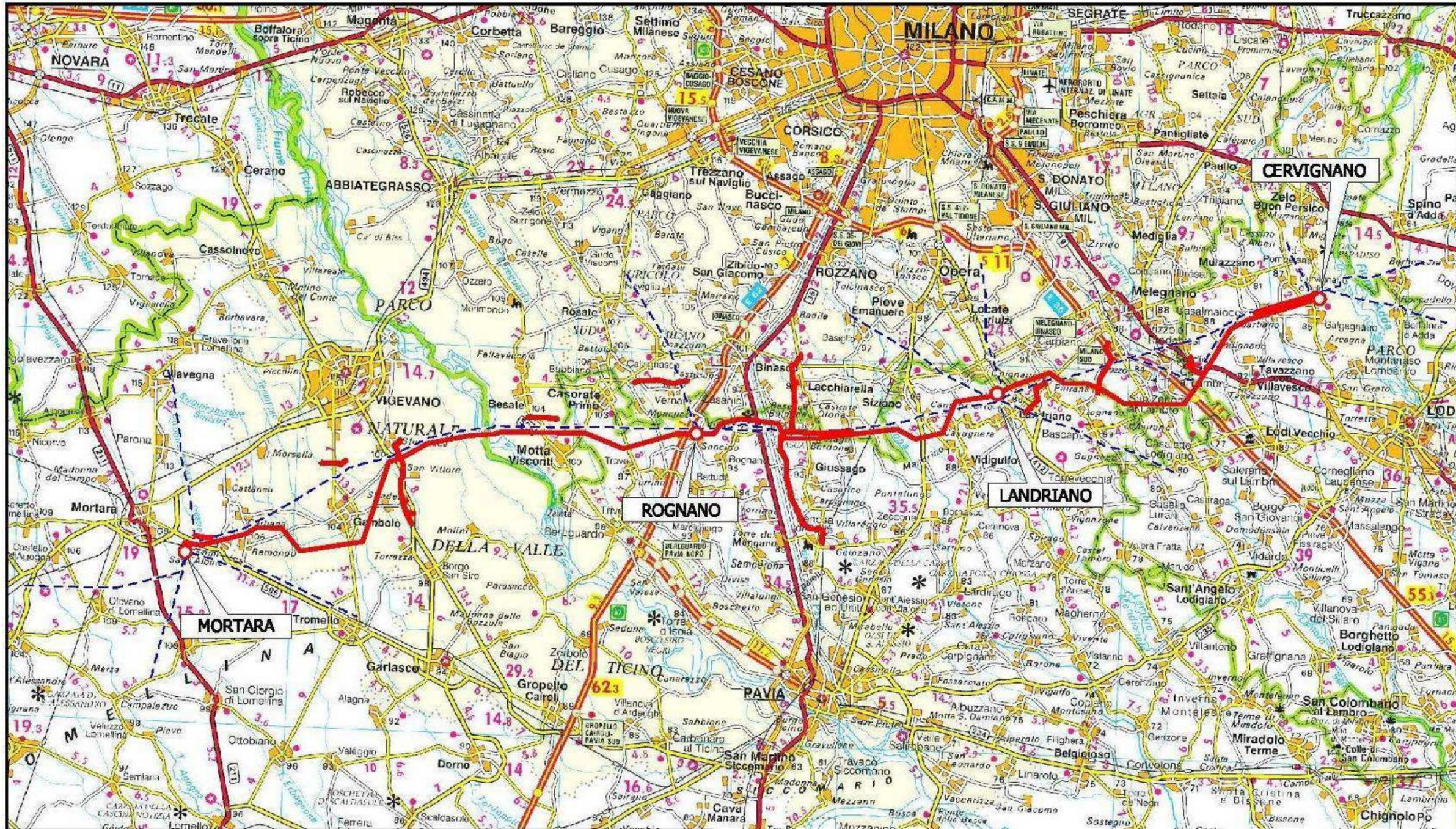
Fig. 0.1 - Inquadramento generale delle opere in progetto identificate nello stralcio in colore rosso (Met. Cervignano-Mortara DN 1400 (56"), DP 75 bar e opere connesse).
