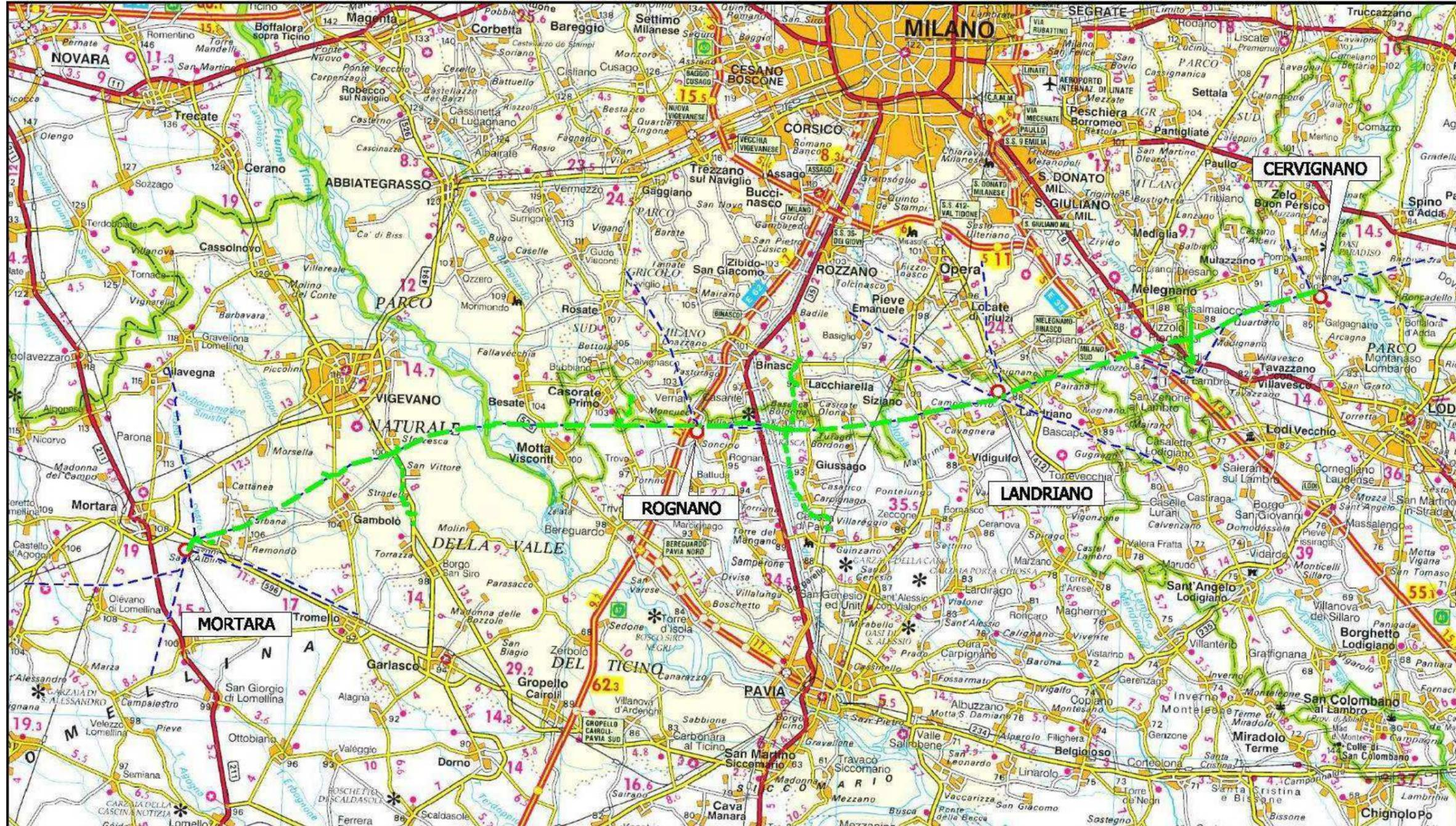
Fig. 0.2 - Inquadramento generale delle opere in dismissione identificate nello stralcio in colore verde (Met. Sergnano-Mortara, tratto Cervignano-Mortara DN 750 (30"), MOP 70 bar e opere connesse).
