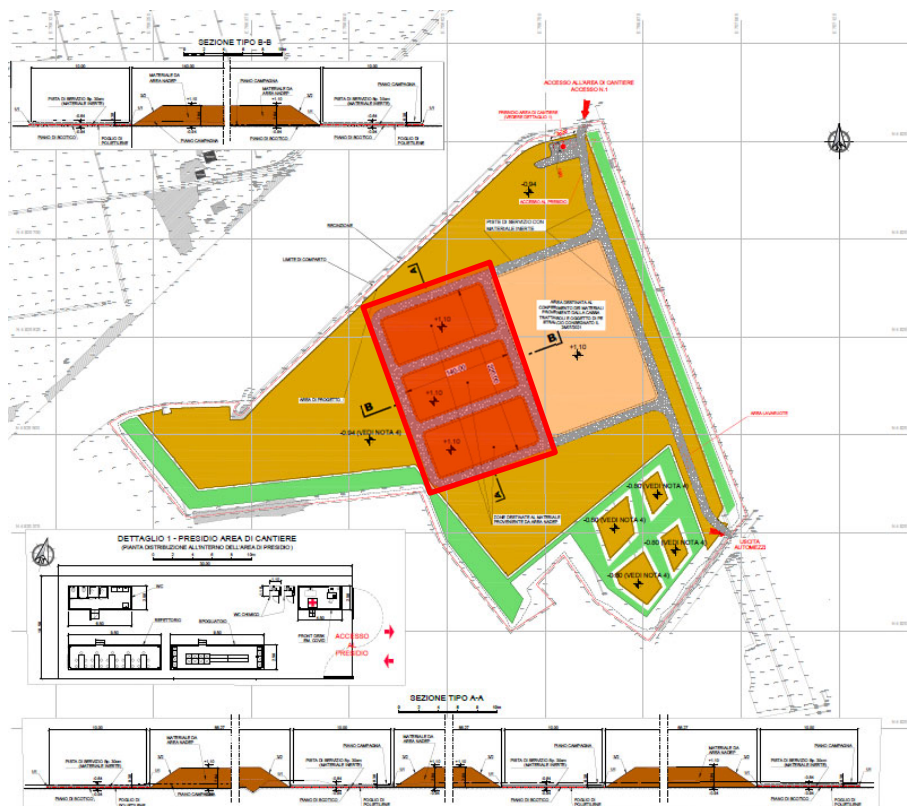
Figura 9 - Planimetria dell'area S3Sud, con evidenza delle aree di deposito dei materiali di scavo (in rosso) e delle sezioni corrispondenti
