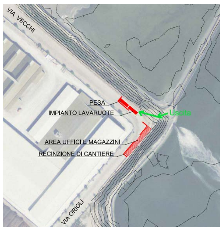
Uscita e area di cantiere
