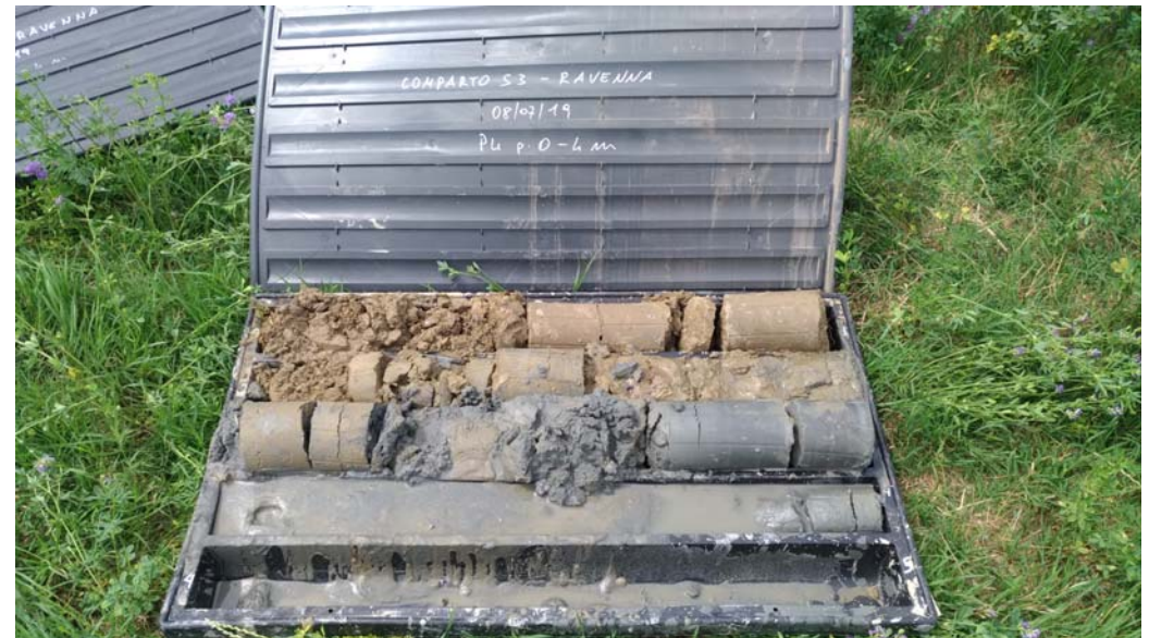
La cassetta del piezometro P4 da 0 a 4 m dal p.c.
