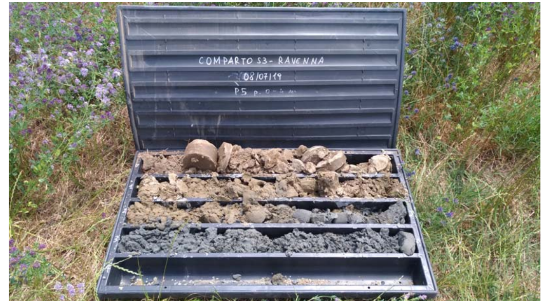
La cassetta del piezometro P5 da 0 a 4 m dal p.c.
