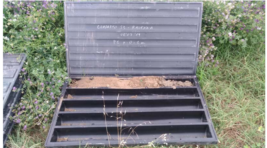
La cassetta del sondaggio P1 da 0 a 1 m dal p.c.
