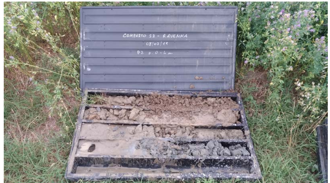
La cassetta del piezometro P2 da 0 a 4 m dal p.c.
