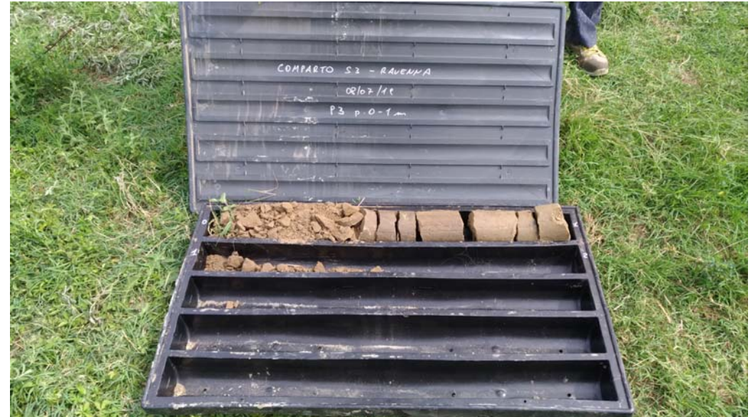
La cassetta del sondaggio P3 da 0 a 1 m dal p.c.
