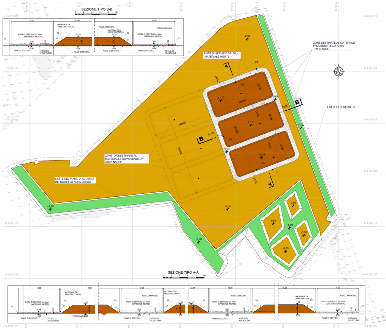
Figura 9 – Planimetria e sezioni tipo delle aree di versamento dei materiali (in marrone) all'interno del comparto S3 sud
