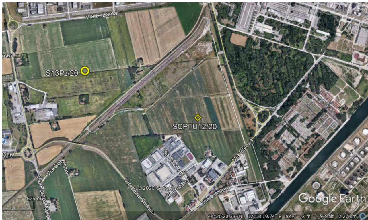
Figura 15– Ubicazione del punto di monitoraggio della falda (S13Pz/20) in corrispondenza dell'area S3
