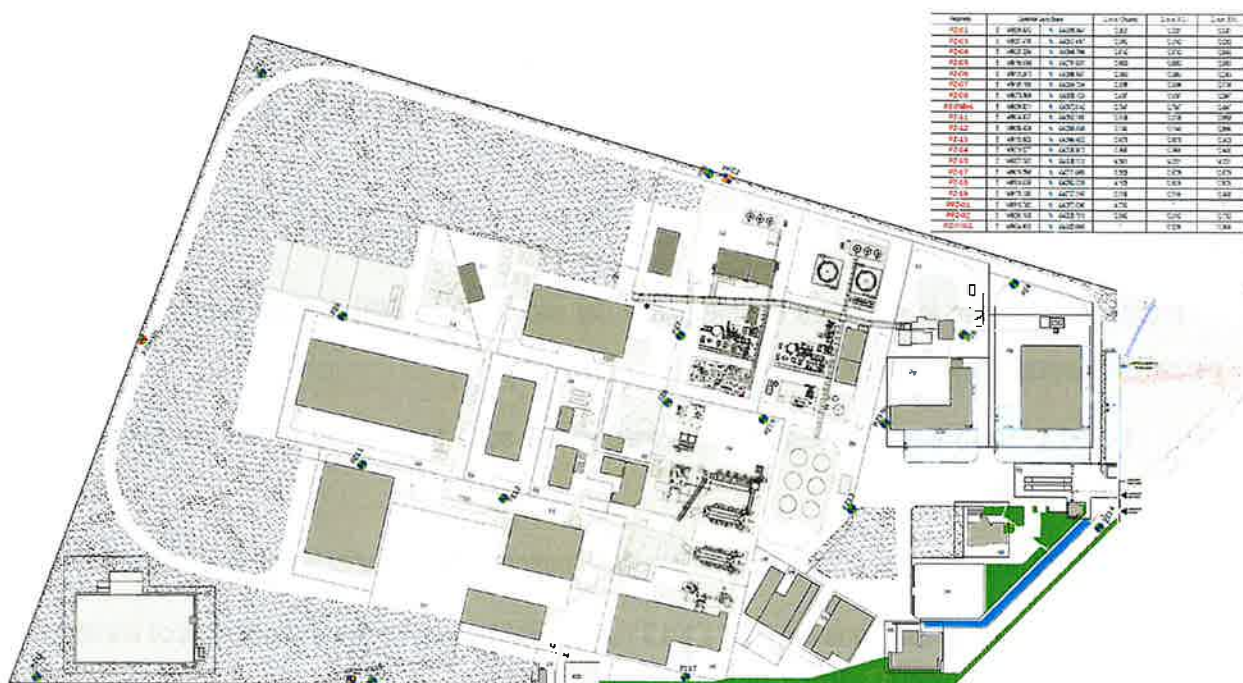
Figura 2-1 Piezometri presenti all'interno dello stabilimento produttivo, con indicazione dell'area di proprietà allargata (SE)
