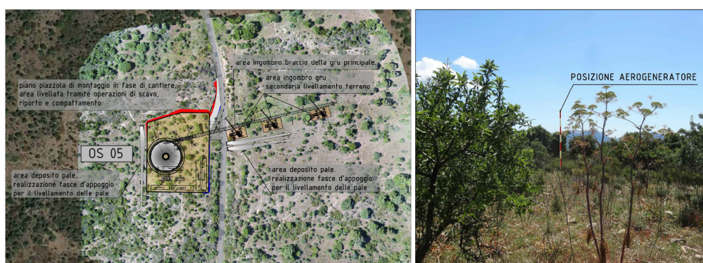
Fig. 38 – ingombri di cantiere su foto area e foto wtg OS 05
