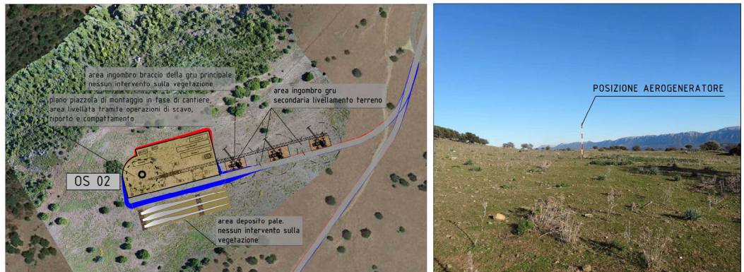
Fig. 32 – ingombri di cantiere su foto area e foto wtg OS 02
