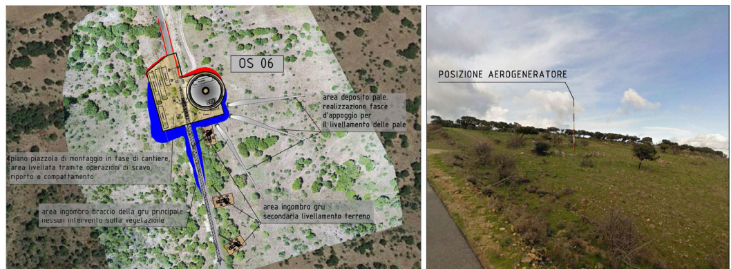
Fig. 40 – ingombri di cantiere su foto area e foto wtg OS 06
