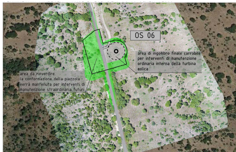
Fig. 41 – ingombri piazzola di servizio post operam
