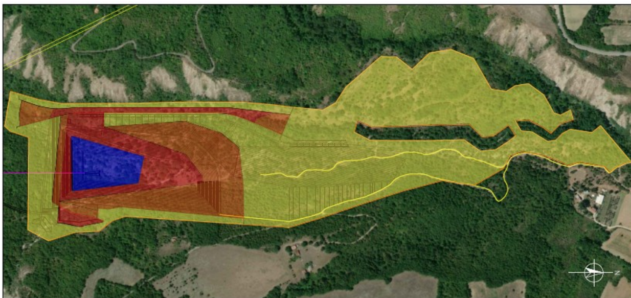
Figura 7.6: Profondità di Scavo delle Aree Superficiali – Cantiere No. 5 (Bacino di Valle)
