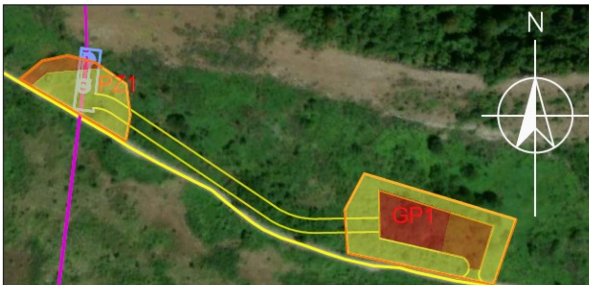
Figura 7.4: Profondità di Scavo delle Aree Superficiali – Cantiere No. 3 (Pozzo Piezometrico)
