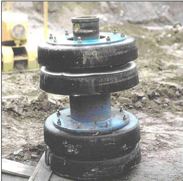
**Fig. 3.24 - Pig convenzionale impiegato nelle operazioni di collaudo idraulico e di pulizia della condotta.**
