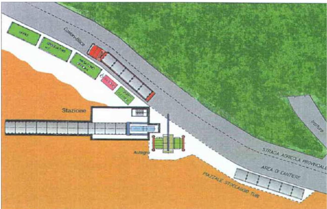
**Fig. 3.12 - Schema tipo di una cantiere per l'installazione di un microtunnel.**
