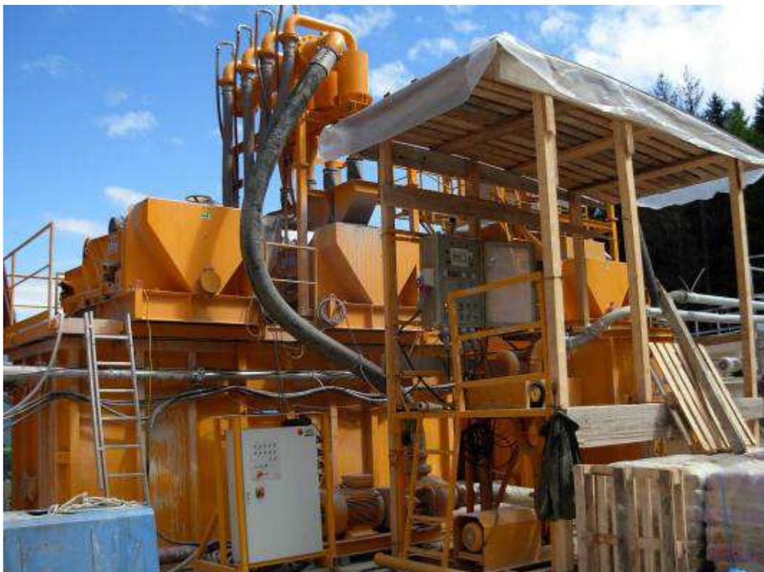
**Fig. 3.14 - Sistema di disidratazione**
