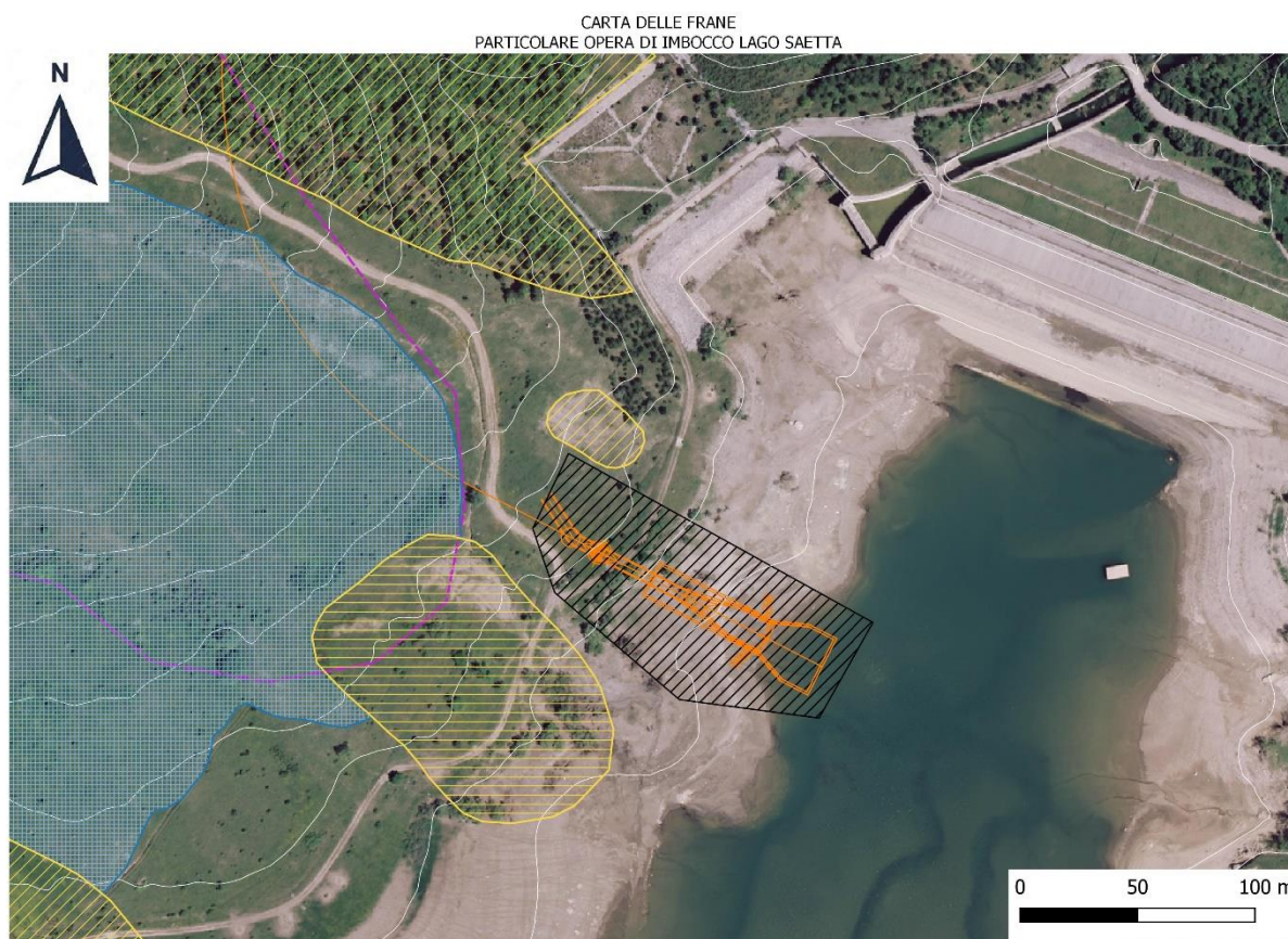
Figura 8-3 Opera di presa in progetto con carta delle frane. In rigato nero l'area di cantiere.
