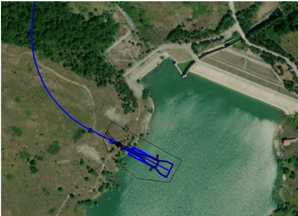
Figura 8-2 Opera di presa in progetto
