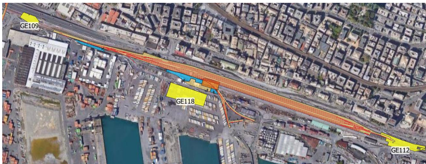
Figura 28 - Planimetria delle opere in progetto e interferenze con i siti oggetto di interventi di bonifica, messa in sicurezza permanente e messa in sicurezza operativa
