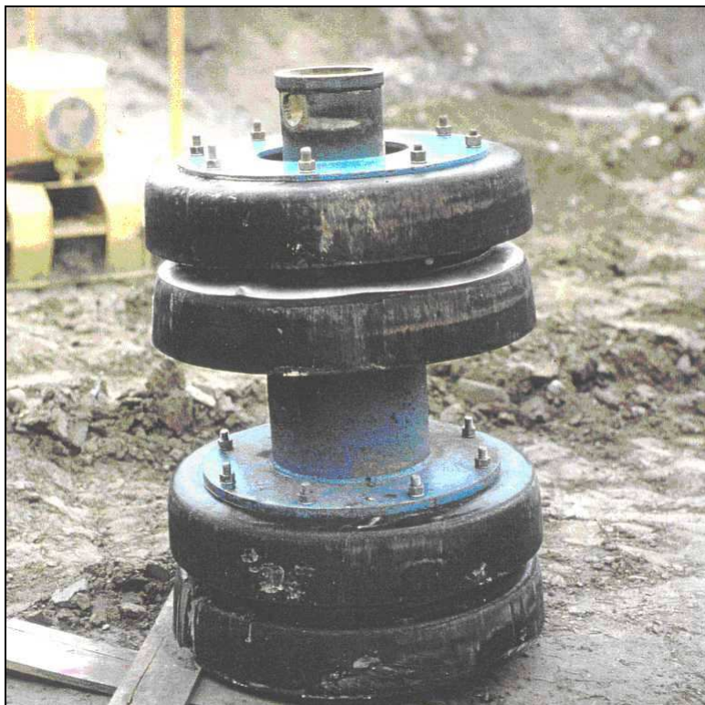
Fig. 2.29 - Pig convenzionale impiegato nelle operazioni di collaudo idraulico e di pulizia della condotta.
