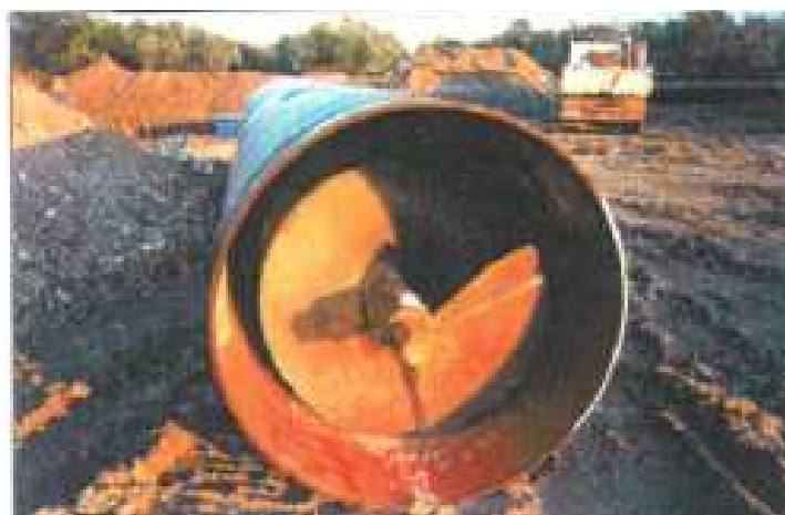
Fig. 2.12 - Coclea per trivella spingitubo.
