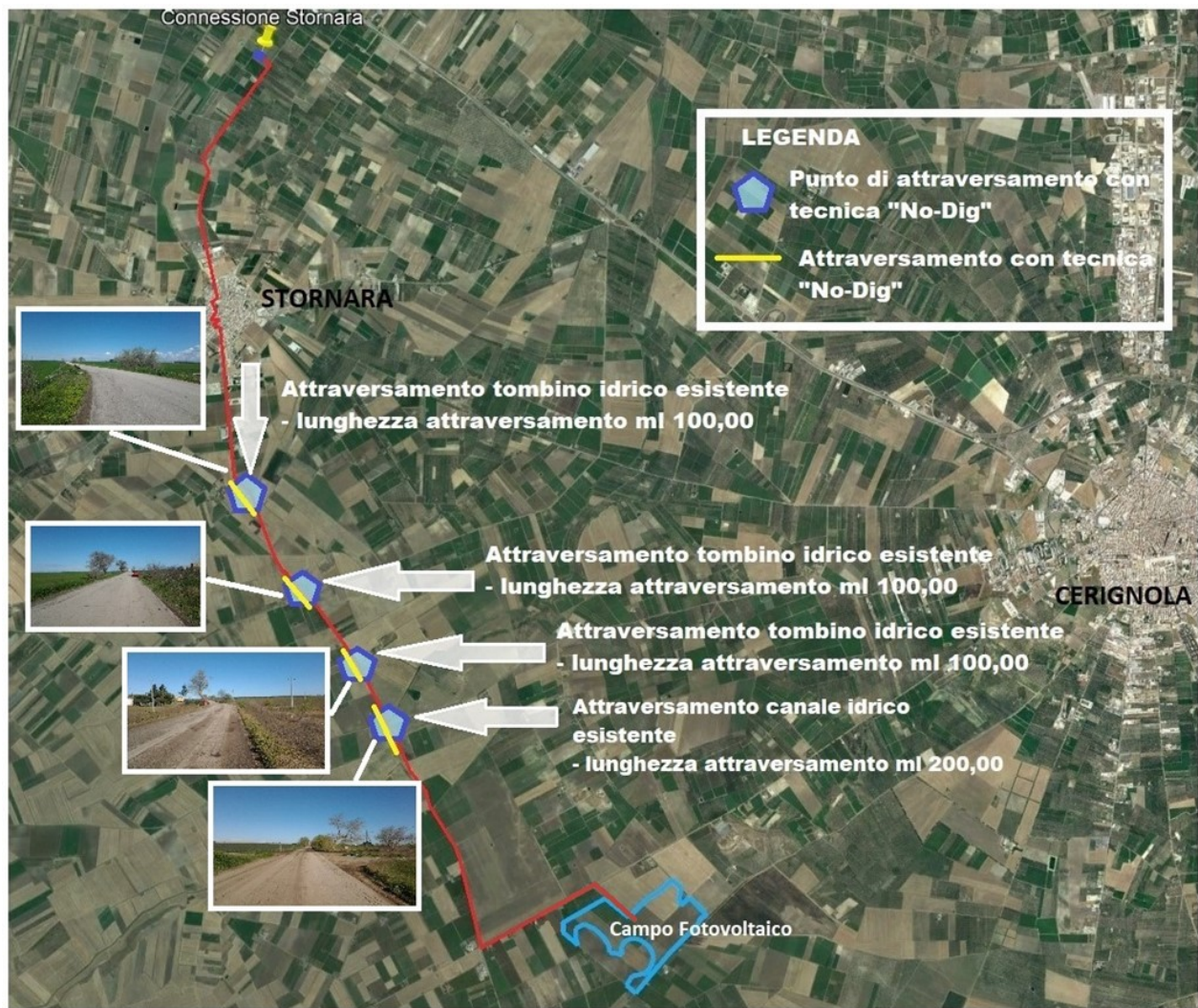
Figure 1-13. Il directional drilling rappresenta sicuramente la più
