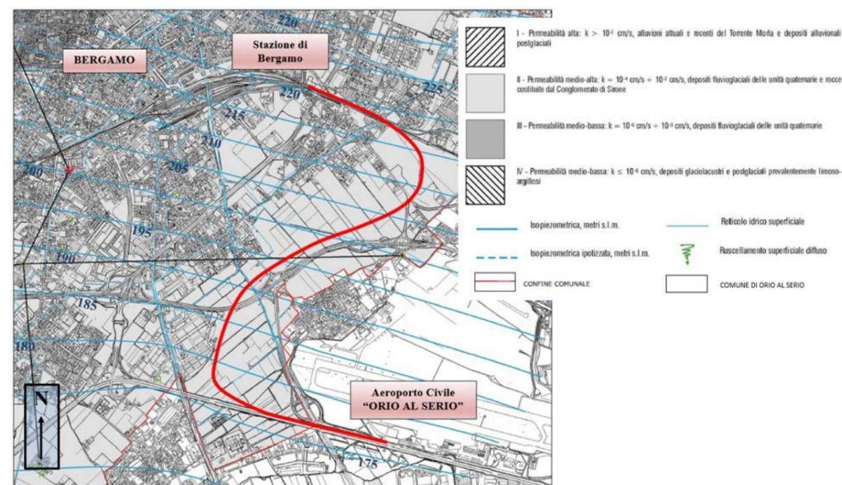
Figura 2-5 – Stralcio non in scala della Carta Idrogeologica e relativa legenda(2011) allegata al Piano di Governo del Territorio del comune di Bergamo. Scala 1: 10.000. La linea in rosso indica il tracciato della ferrovia in progetto.
