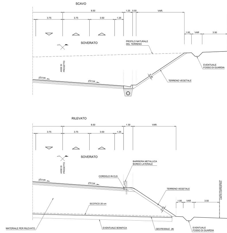
SEZIONE TIPO CON CORSIA DI ARRAMPICAMENTO
