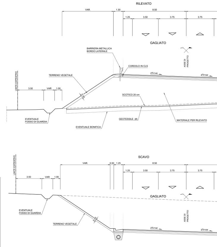
SEZIONE TIPO CON DETTAGLIO PROTEZIONE RILEVATO
