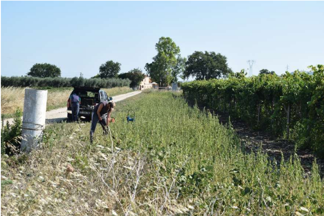
Energizzazione con mazza battente onde longitudinali (MASW)
