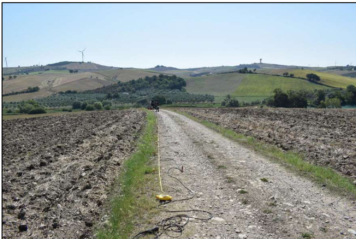
Foto n. 4 – esecuzione indagine sismica
