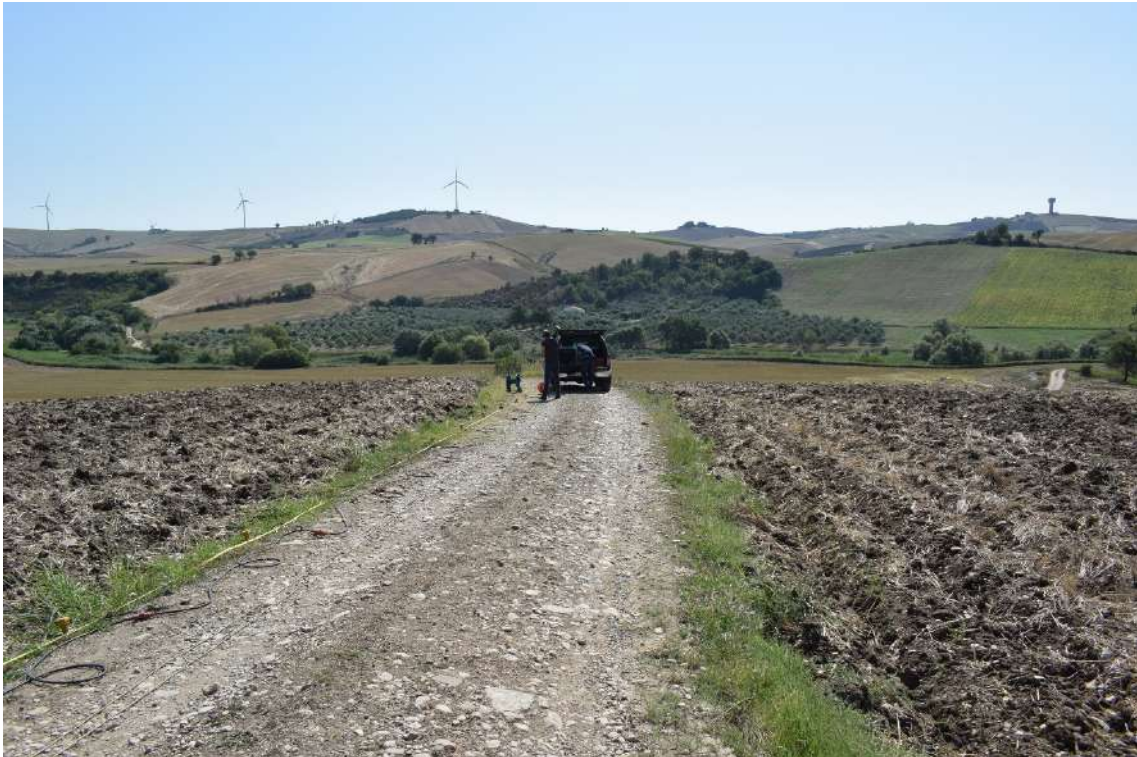
Energizzazione con mazza battente onde longitudinali (MASW)
