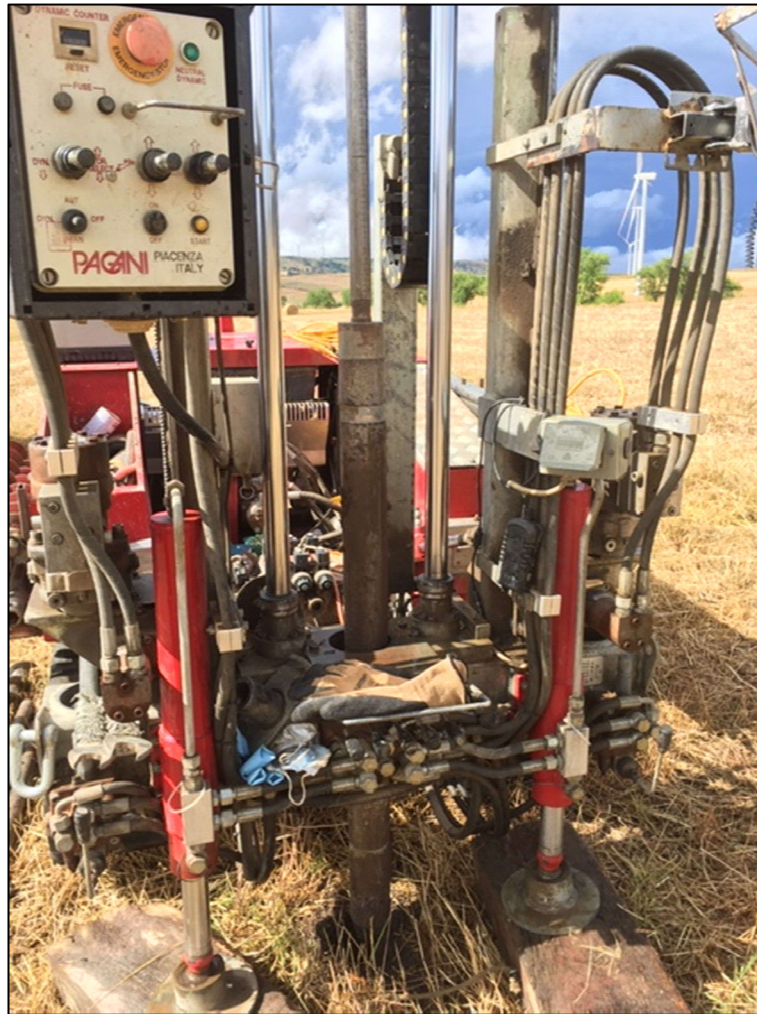
Figura 4. Esempio di campionatore da 60 mm
