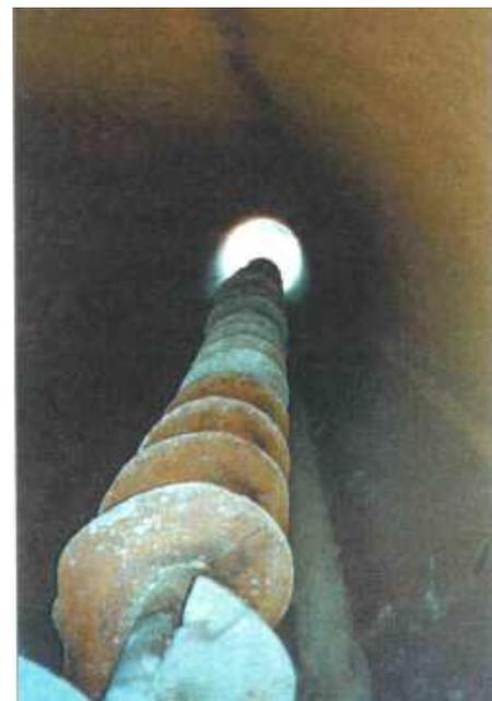
**Fig. 2.12 - Coclea per trivella spingitubo.**
