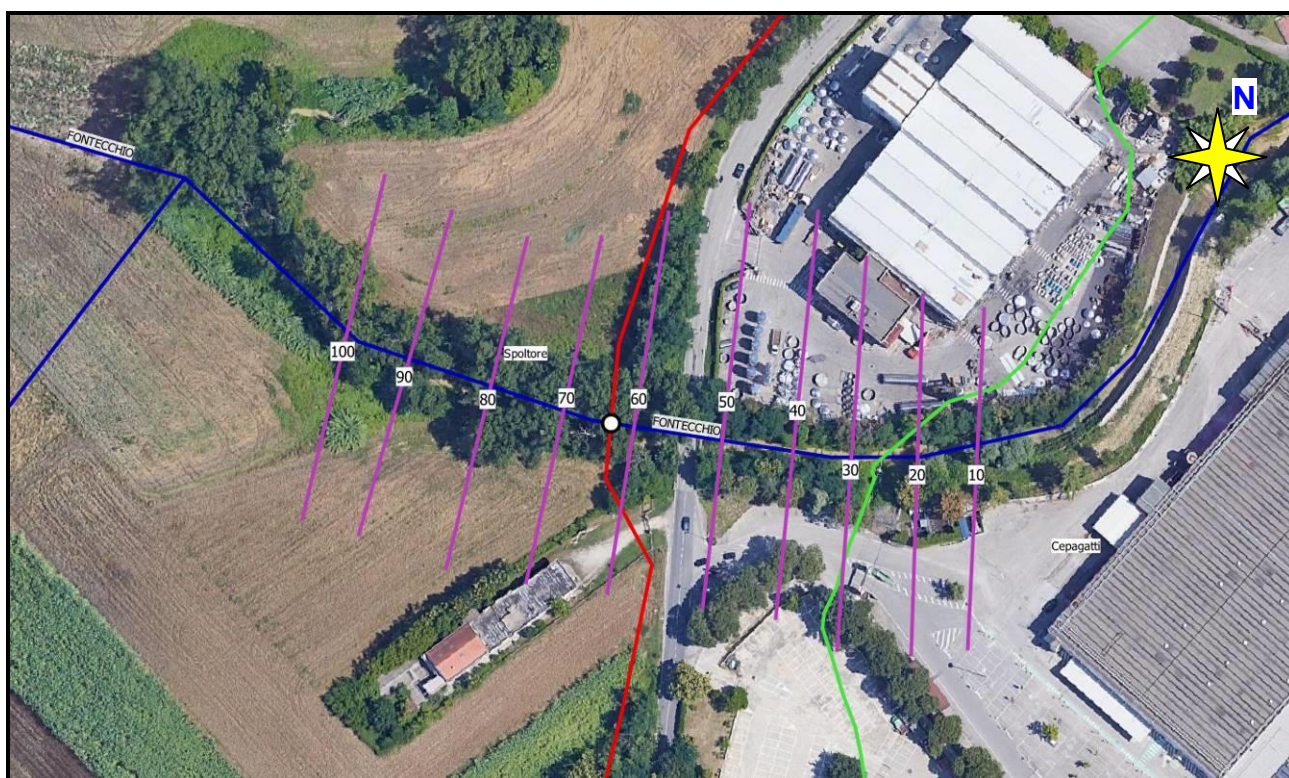
Fig.5.2/A: Foto aerea, con tronco d'alveo analizzato e sezioni di input
