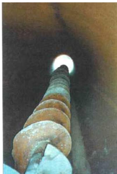
**Fig. 4.3 - Coclea per trivella spingitubo.**
