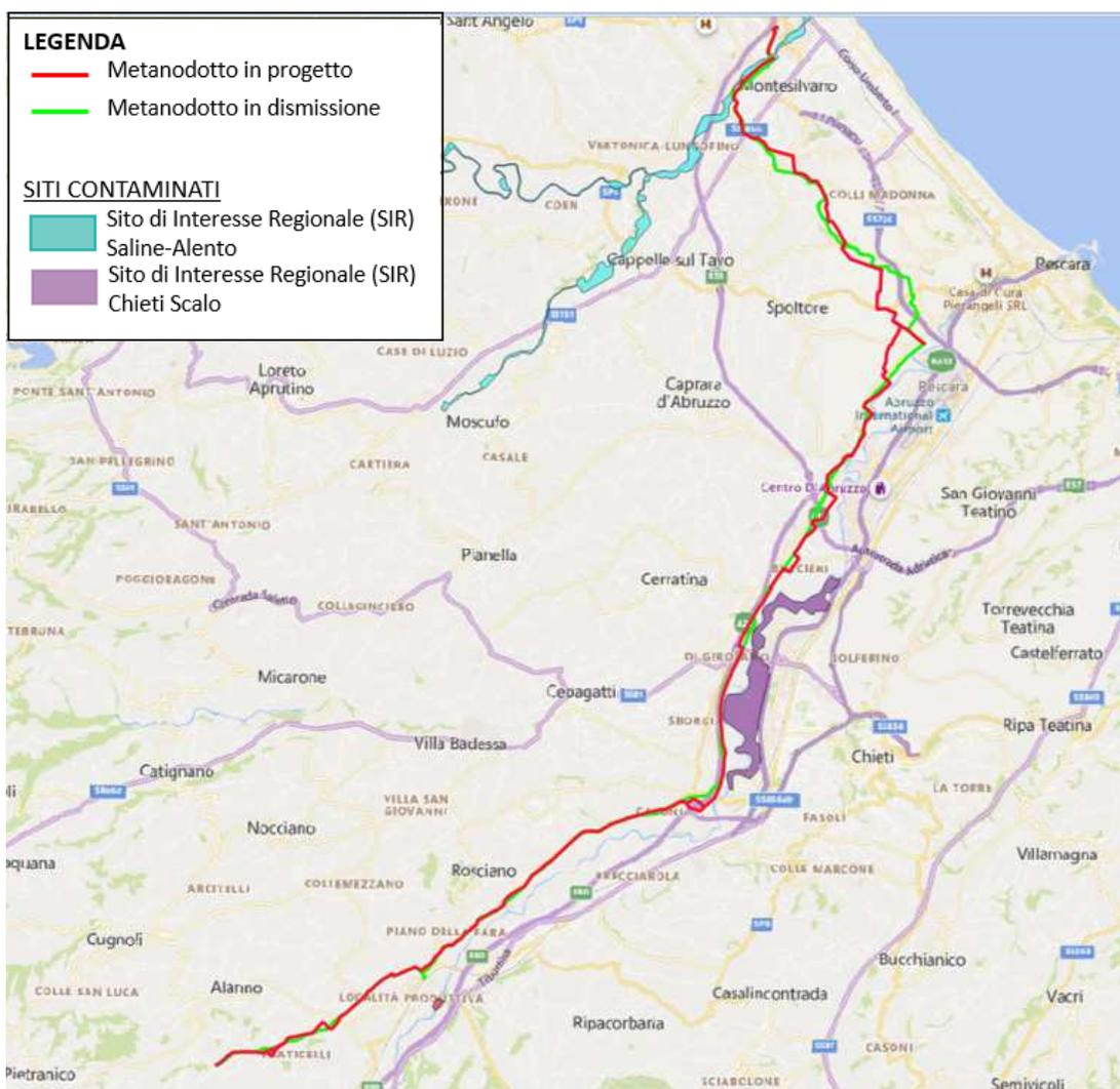
Fig. 3.2 – Interferenza delle opere in oggetto con SIR.
