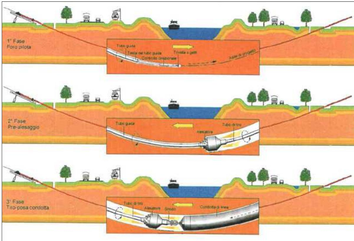
**Fig. 4.4 - Le tre fasi operative per una TOC**
