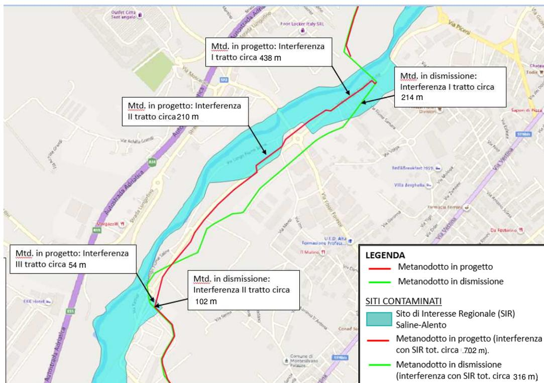
**Fig. 3.3 – Dettaglio della percorrenza all'interno del SIR Saline-Alento.**
