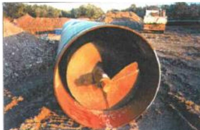
**Fig. 6.1 - Coclea per trivella spingitubo**
