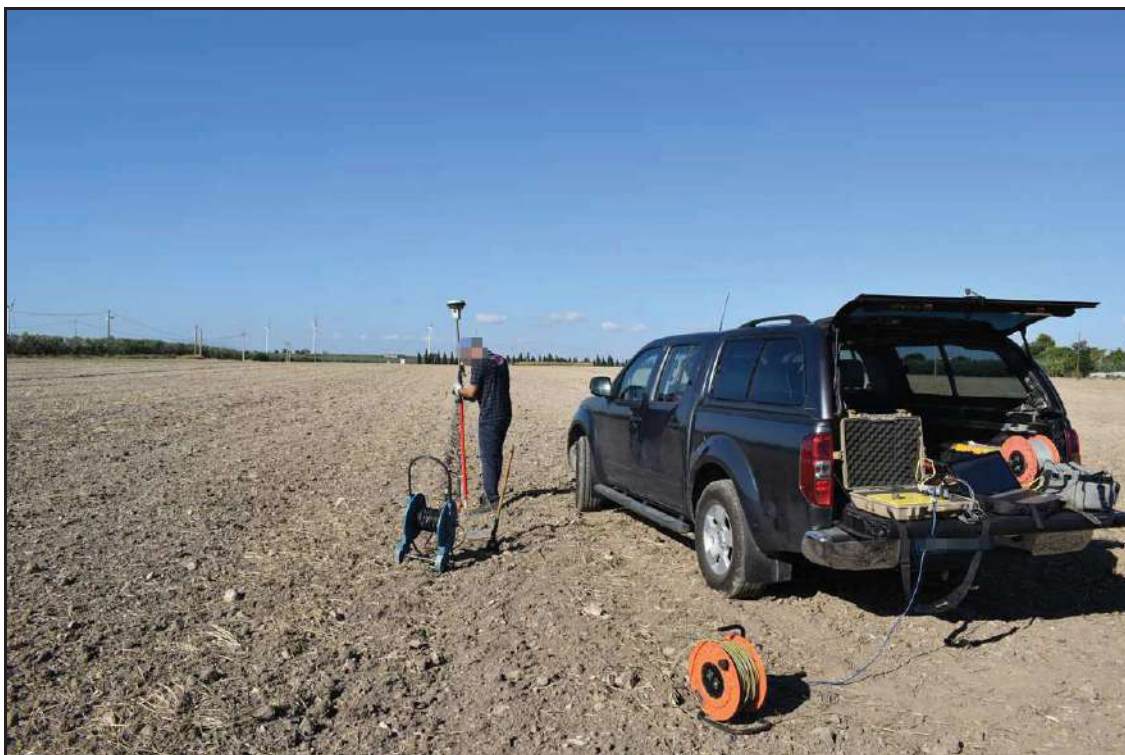
Foto n. 1 – georeferenziazione traccia sismica S1
