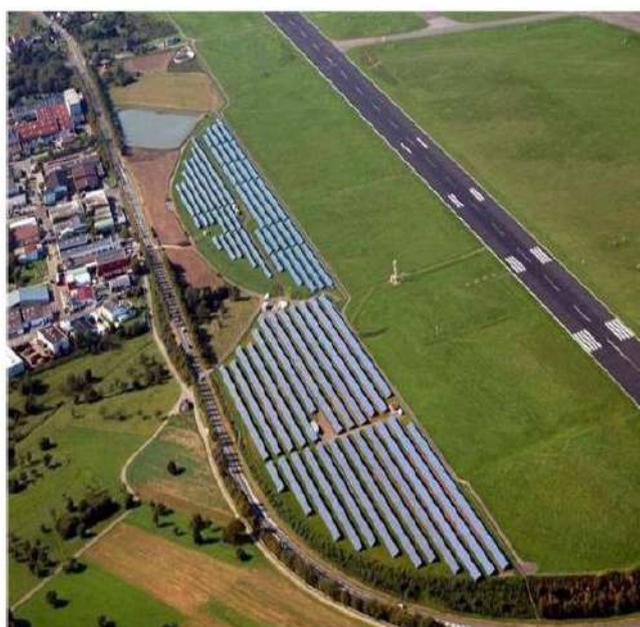
***Fig.6 Esempi di impianti fotovoltaici in ambito aeroportuale. La disposizione dei moduli fotovoltaici in prossimità delle piste di atterraggio/decollo non rappresenta un rischio per la sicurezza.***
