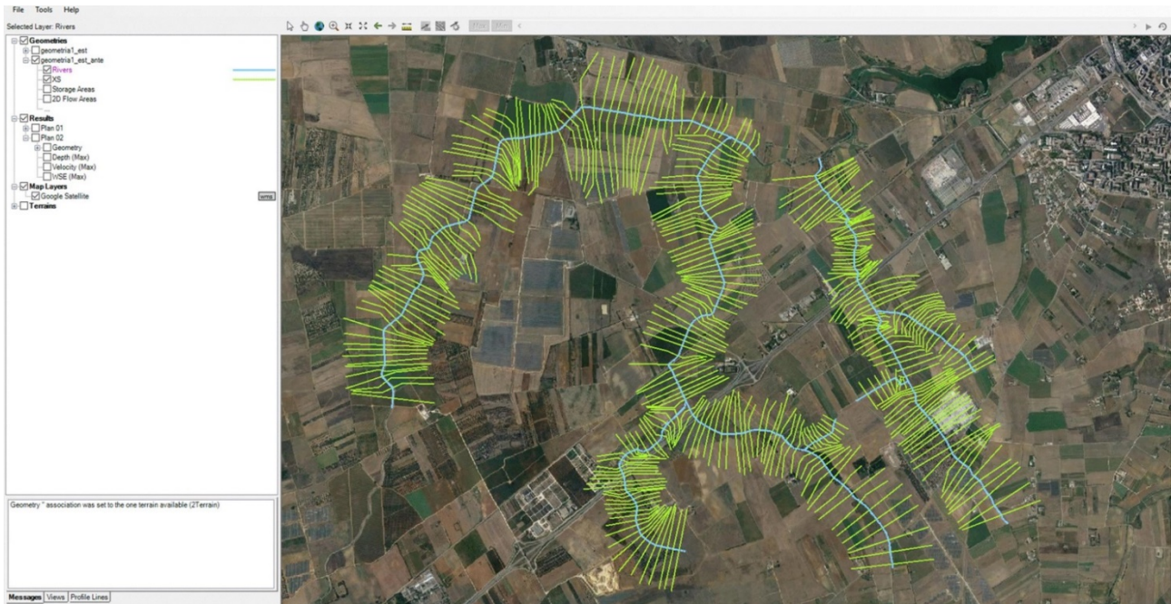
Figura 27. Sezioni di calcolo per i corsi d'acqua più a est. Le sezioni sono perpendicolari all'asse del corso d'acqua nelle sue vicinanze. Esse sono sovrapposte alle ortofoto prese da Google Maps, su RAS Mapper.
