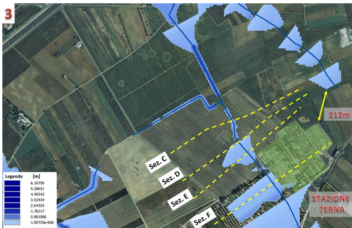
Figura 40. Floodplain su ortofoto con indicazione della stazione Terna e di quattro sezioni di calcolo (Sez. C, Sez. D, Sez. E, Sez. F). La legenda indica l'altezza del tirante idrico rispetto al suolo. Condizione ante operam, in assenza di ampliamento della stazione.
