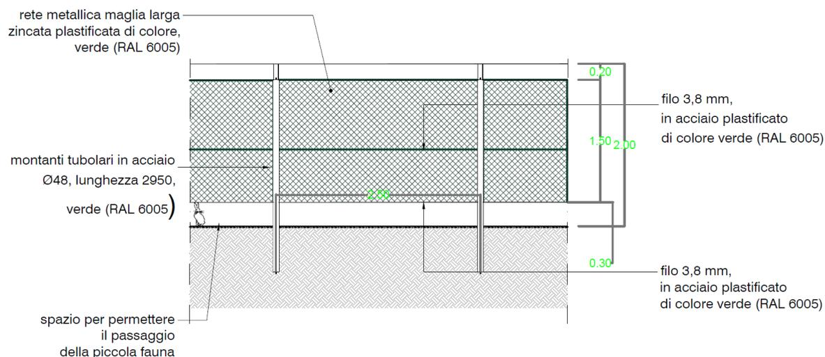
*Figura 16: Particolare recinzione con presenza di uno spazio sottostante riservato al passaggio della piccola fauna*
