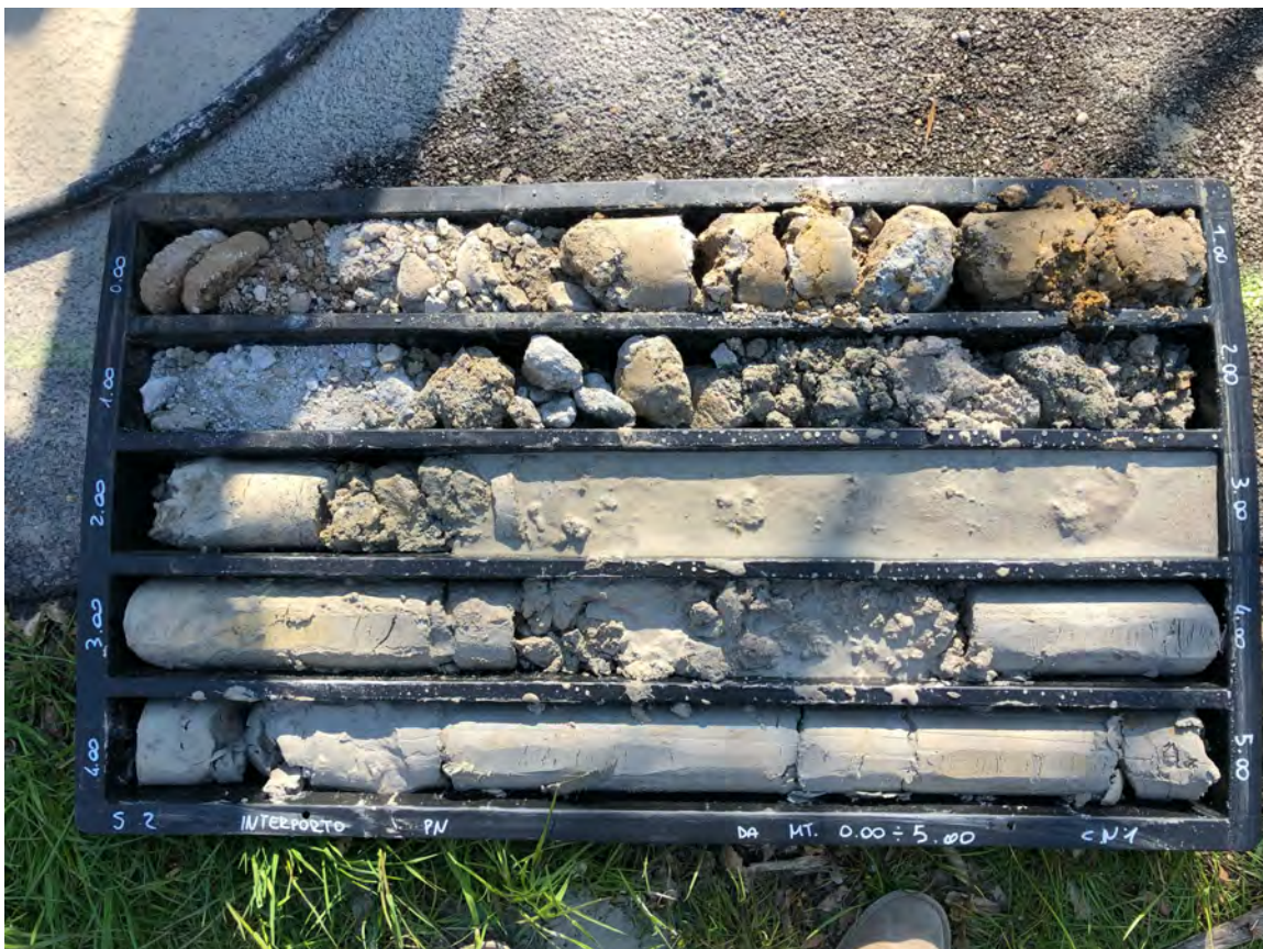
Sondaggio N° 2, cassetta N° 1, da m 0 a m 5
