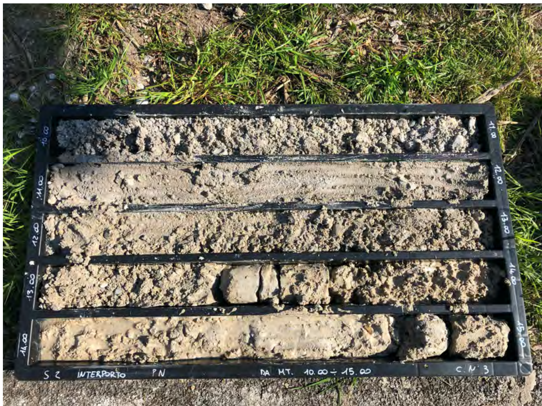
Sondaggio N° 2, cassetta N° 3, da m 10 a m 15
