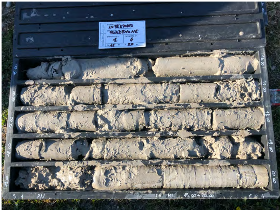
Sondaggio N° 1, cassetta N° 4, da m 15 a m 20
