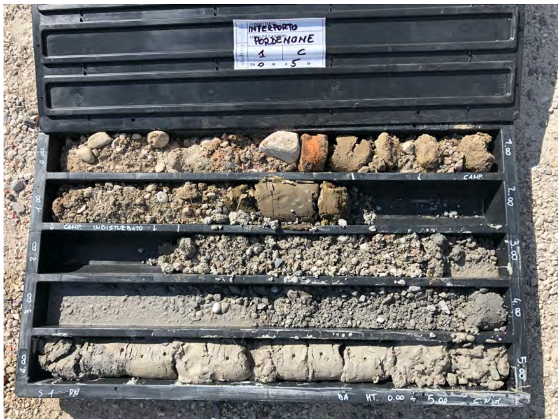
Sondaggio N° 1, cassetta N° 1, da m 0 a m 5
