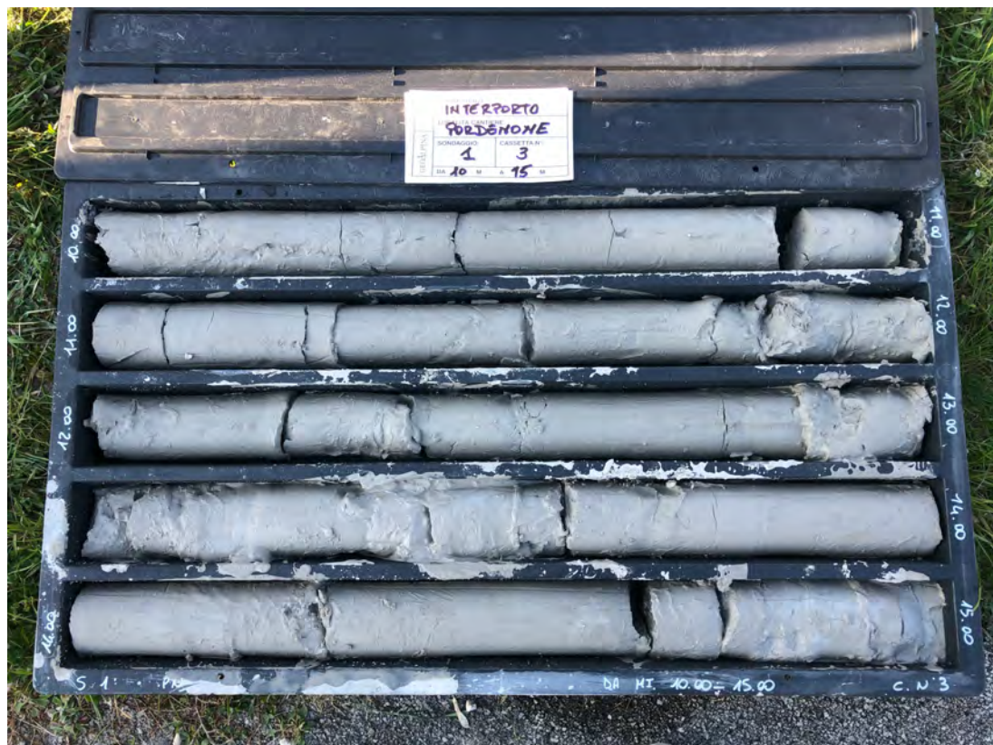
Sondaggio N° 1, cassetta N° 3, da m 10 a m 15
