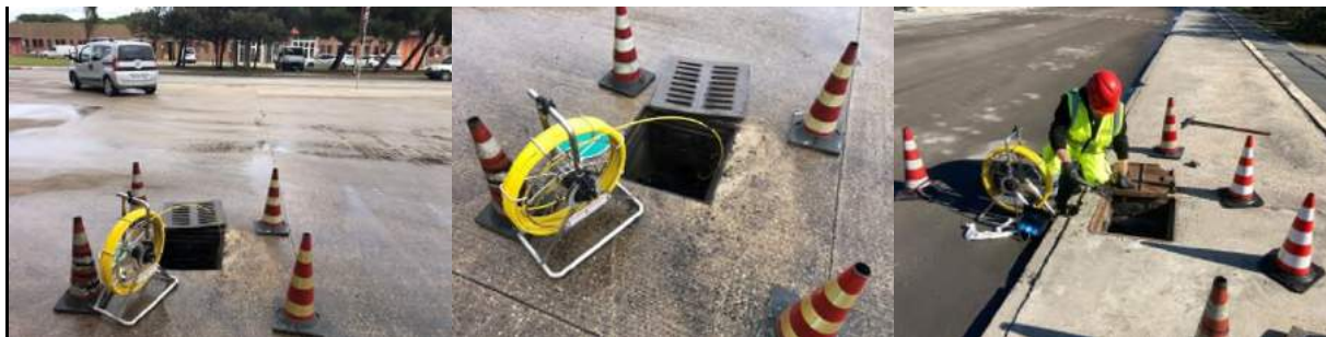
Telecamere speciali per videoispezione di tubazioni, in nostra dotazione.
