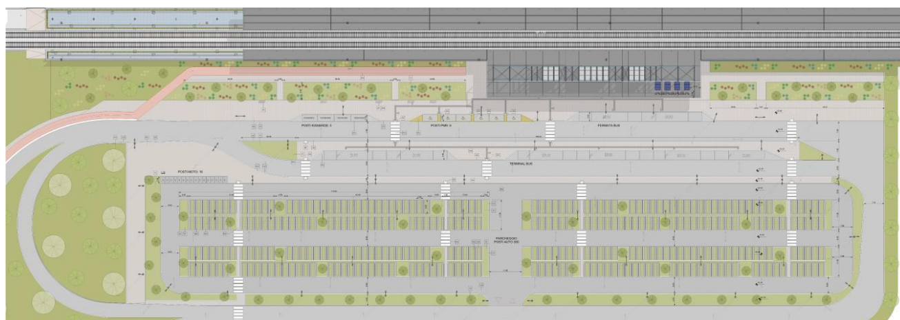
Figura 17 – Parcheggio di interscambio intermodale (auto, BRT, bici)
