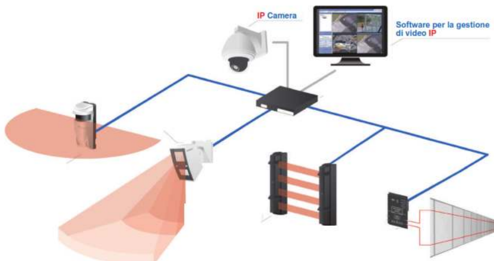
Fig. 20 Sistema di videosorveglianza e antintrusione
